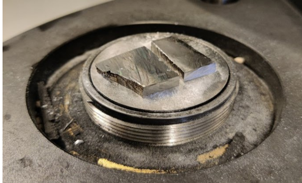
Kuva 5. Tutkittava materiaali asetettu valualustalle.
