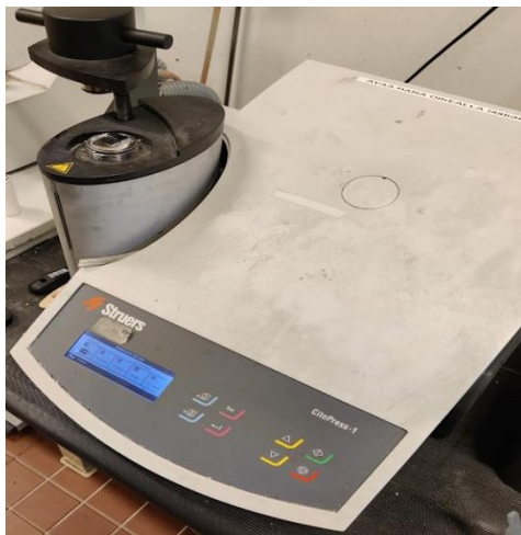
Kuva 4. Struers Citro Press-1. Kuumavalupainelaite.
