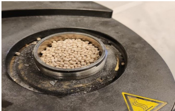
Kuva 6. Muovirakeet lisätty tutkitavan materiaalin päälle valumuottiin.
