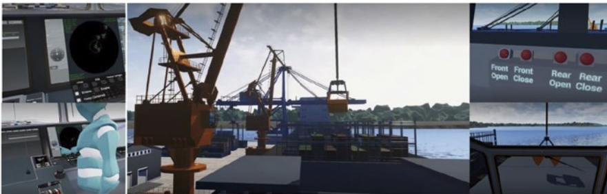
Kuva 3. Komentosillan ja nosturin välistä vuorovaikutusta tarvitaan mm. ruuman luukun avaamisessa.
