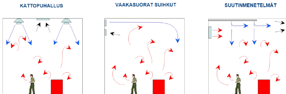
Kuva 4. Tyypilliset sekoitusperiaatteisen ilmanvaihdon havainnekuvat. (Hautalampi 2008, 51)
