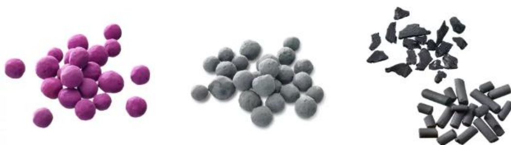
Kuva 18 Molekyylisuodattimien rakeisia massoja. Vasemmalla aktivoitu alumiinioksidia, keskellä hybridi- ja sekamassa, oikealla aktiivihiihtä. (Camfil 2022a.)
