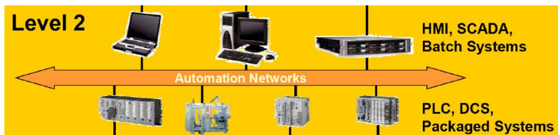
Kuvio 4. Automaatioverkko [2]. Erityyppiset laitteet on samassa Ethernet verkossa.
