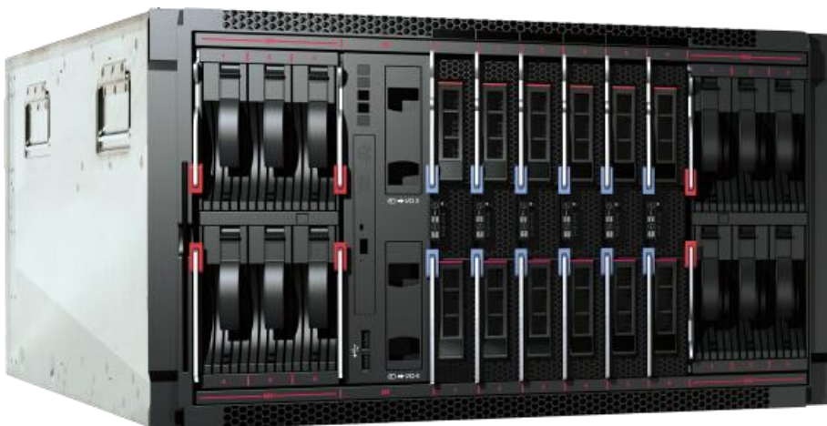
Kuvio 10. IBM:n BladeCenter S -tietokeskus käytetään Honeywell'in Experion Virtualization Solution Premium-toteutuksessa. Koko on U7
