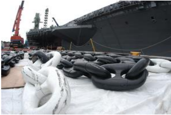
Figur 5. Ankarkättingens längdmarkering på hangarfartyget USS Kitty HAWK med stolpkätting (collector, 2009).
