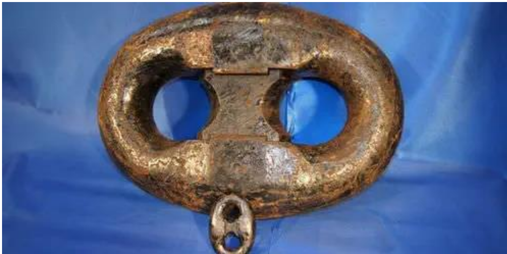
Figur 3. Kenter-Schackel, en öppningsbar länk kallas även lås. (Damen, 2022)
