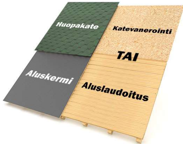
Kuvio 12. Bitumikaton rakenne. (kattoremontti.pro)
