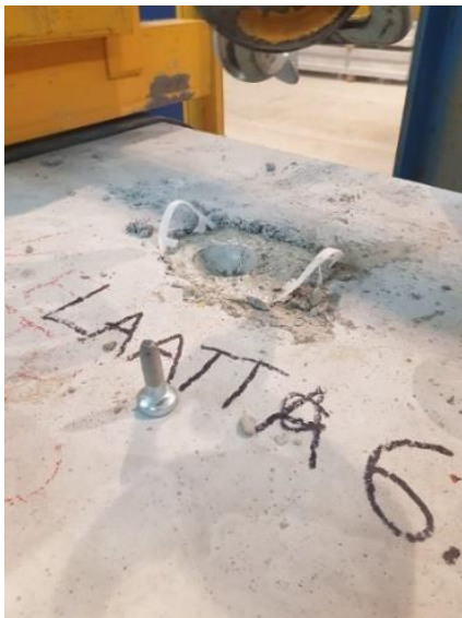
Kuva 36. Koestus 6, ontelolaatan kuula-ankkurin pettäminen.
