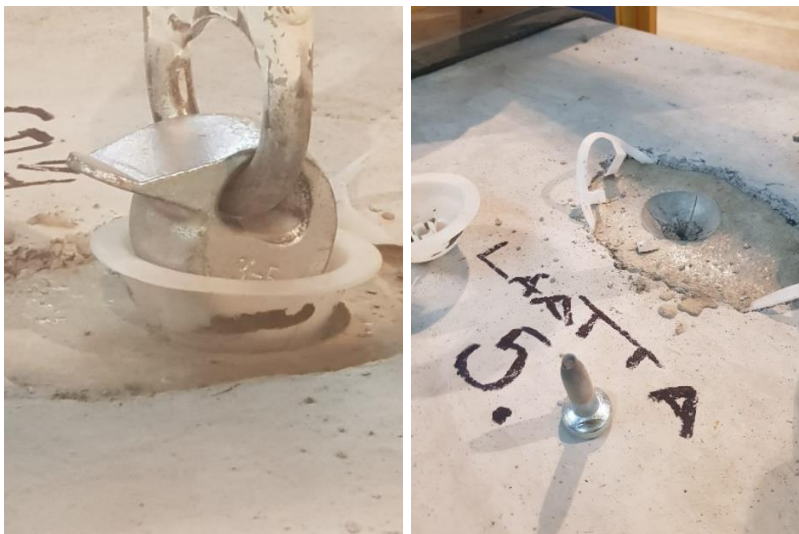
Kuva 32. Koestus 5, ontelolaatan kuula-ankkurin pettäminen.
