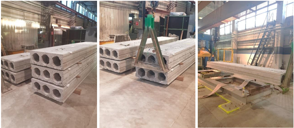
Kuva 15. P32-ontelolaatan siirto koekuormituslaitteelle.
