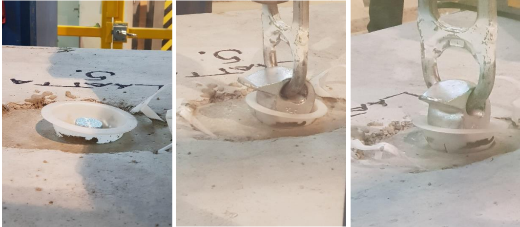
Kuva 31. Koestus 5, ontelolaatan kuula-ankkurin asennuksen vinous.
