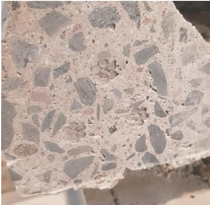
Kuva 14. P32-ontelolaatan onnistunut punostus.
