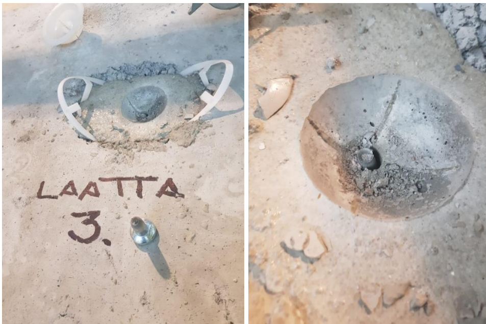
Kuva 27. Koestus 3, ontelolaatan kuula-ankkurin pettäminen.
