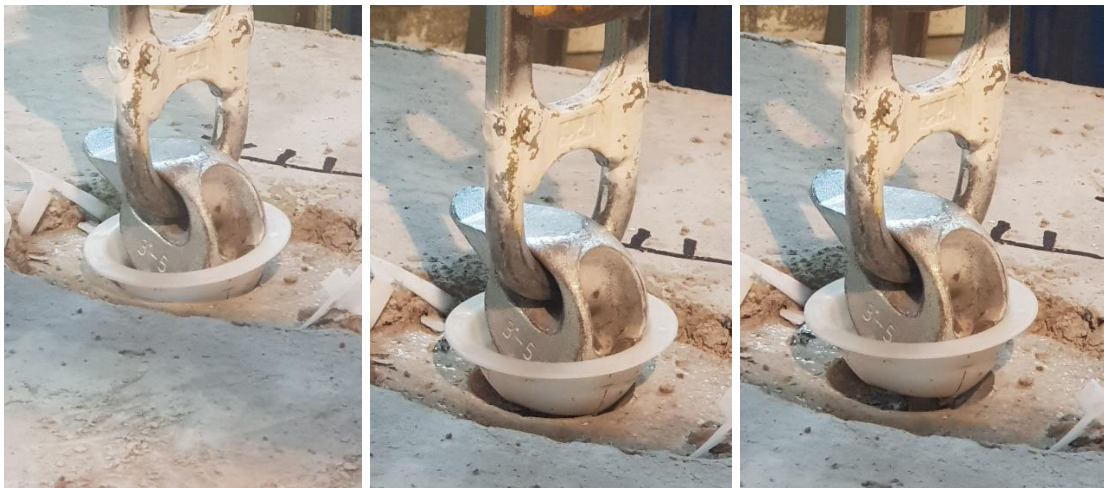
Kuva 25. Koestus 3, ontelolaatan kuula-ankkurin venymä.
