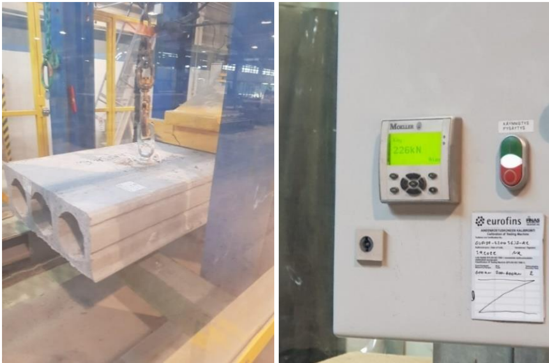
Kuva 17. Koestus on käynnissä ja mittari näyttää puristusvoiman ontelolaatalle.
