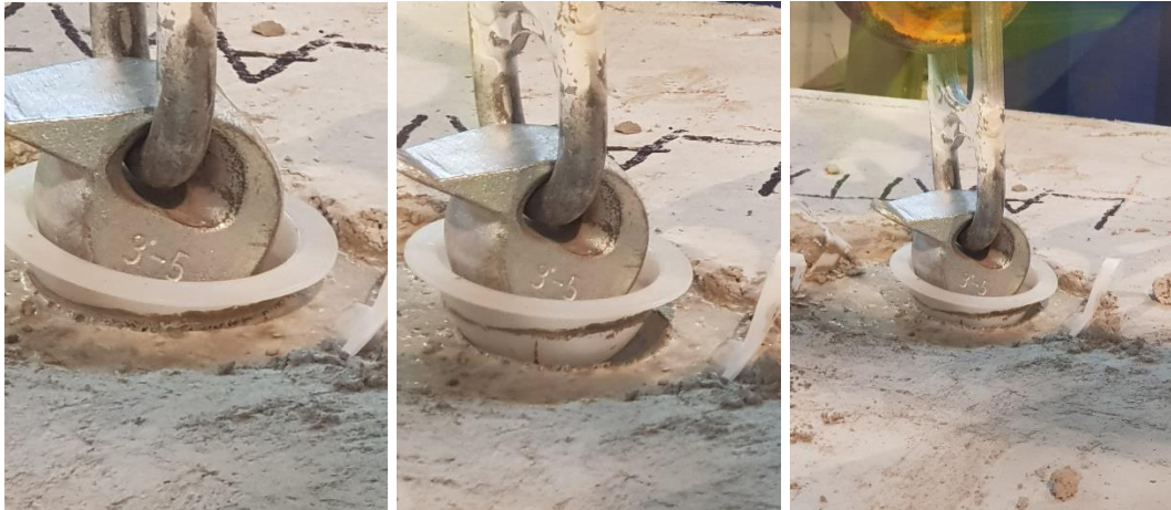
Kuva 35. Koestus 6, ontelolaatan kuula-ankkuri venymä.
