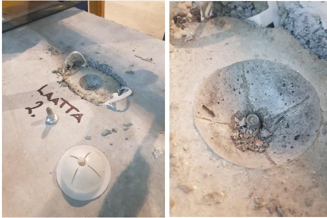
Kuva 22. Koestus 2, ontelolaatta kuula-ankkurin pettäminen.
