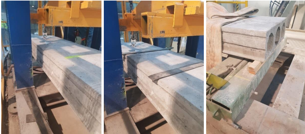
Kuva 16. P32-ontelolaatan asetus koestuslaitteelle.
