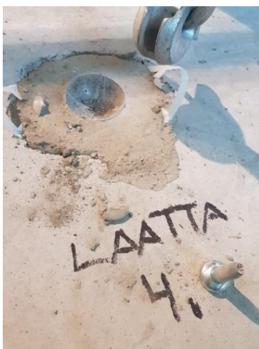
Kuva 29. Koestus 4, ontelolaatan kuula-ankkurin pettäminen.
