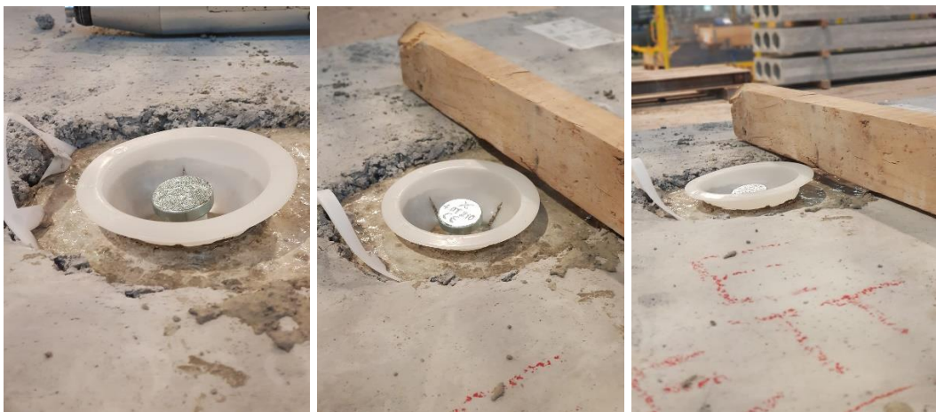
Kuva 34. Koestus 6, ontelolaatan kuula-ankkurin vinous.
