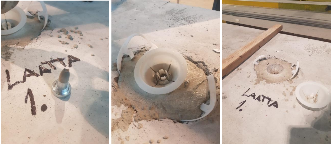
Kuva 19. Koestus 1, ontelolaatan kuula-ankkurin pettäminen.
