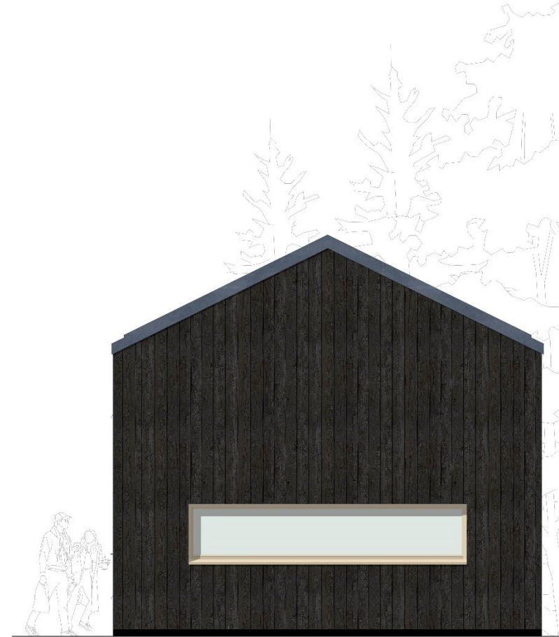
Päätyjulkisivu räystäättömästä rakennuksesta. Kuva 5
