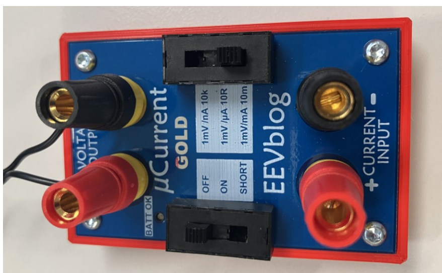
Kuva 7. Hyvin pienten virtojen mittauksen mahdollistava, kolmella valittavalla shunttivastuksella varustettu \mu Current Gold -adapteri.
