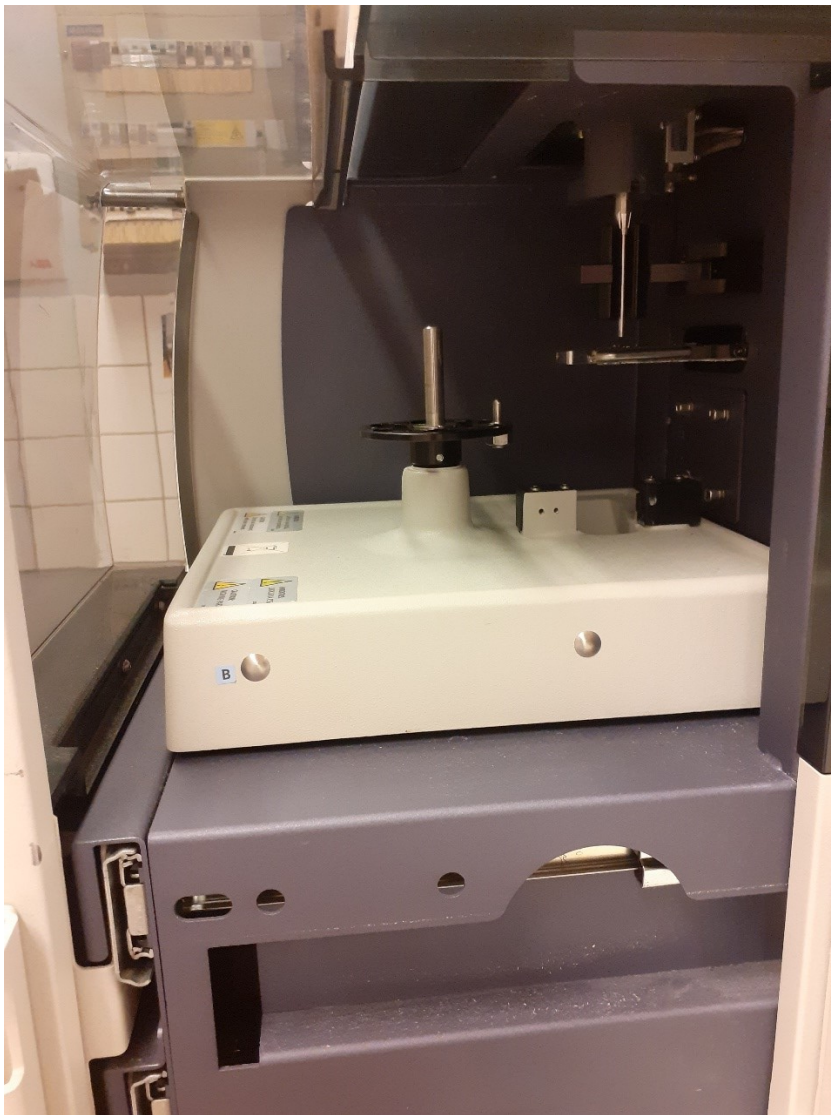
Kuva 2. Virtaussytometrin metallinen näyteneula.
