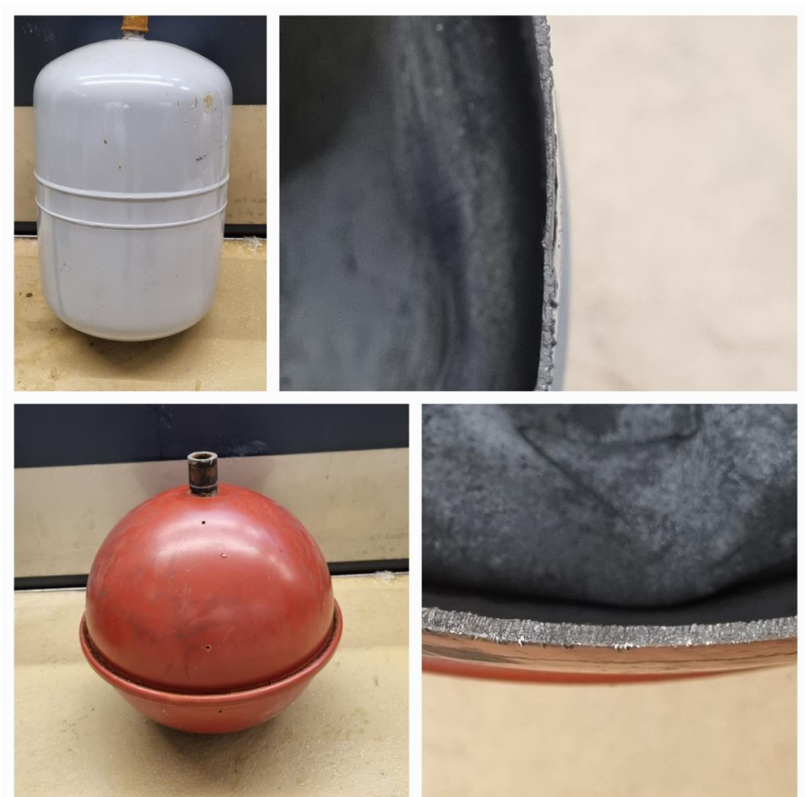
KUVA 8. Kaksi kalvopaisunta-astiaa. Ylhäällä harmaa Reflex seinämävahvuus 1 mm, alhaalla pyöreä Reflex seinämävahvuus 3 mm
