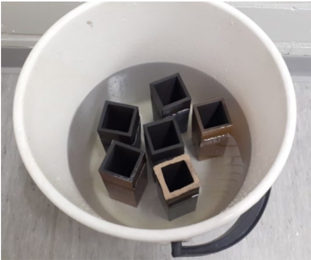
Kuva 11. Vedenläpäisevyytestaus. Kuva: Mikko Nykänen.
