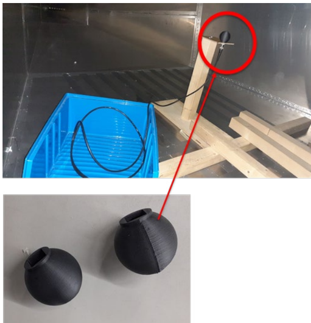
Kuva 13. Radiosignaalin läpäisevyyden mittausjärjestely GTEM-kammiossa. Kuva: Mikko Nykänen.
