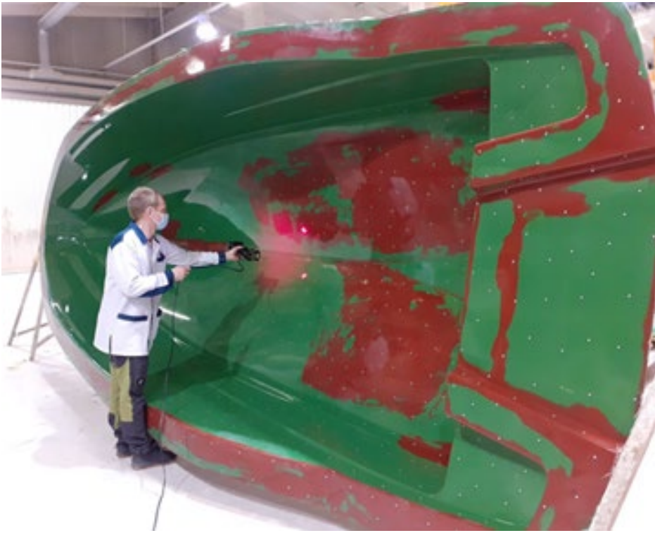
Kuva 23. Mikko Nykänen 3D-skannaa veneen muotin runkoa ja sisäpohjaa. Kuvassa pienet pyöreät tarrat ovat skannauksen aikana käytettyjä kohdistusmerkkejä. Kuva: Eetu Huttunen.
