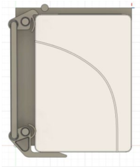
Kuva 25. Teollisuustietokoneen kovalevyn kiintolevykelkan ejektointimekanismin yksi versio. Tummempi osa kuvaa suunnitellun kovalevyn ulostyöntömekanismin yhtä versiota. Kuva Fusion 360 ohjelmasta: Mikko Nykänen.
