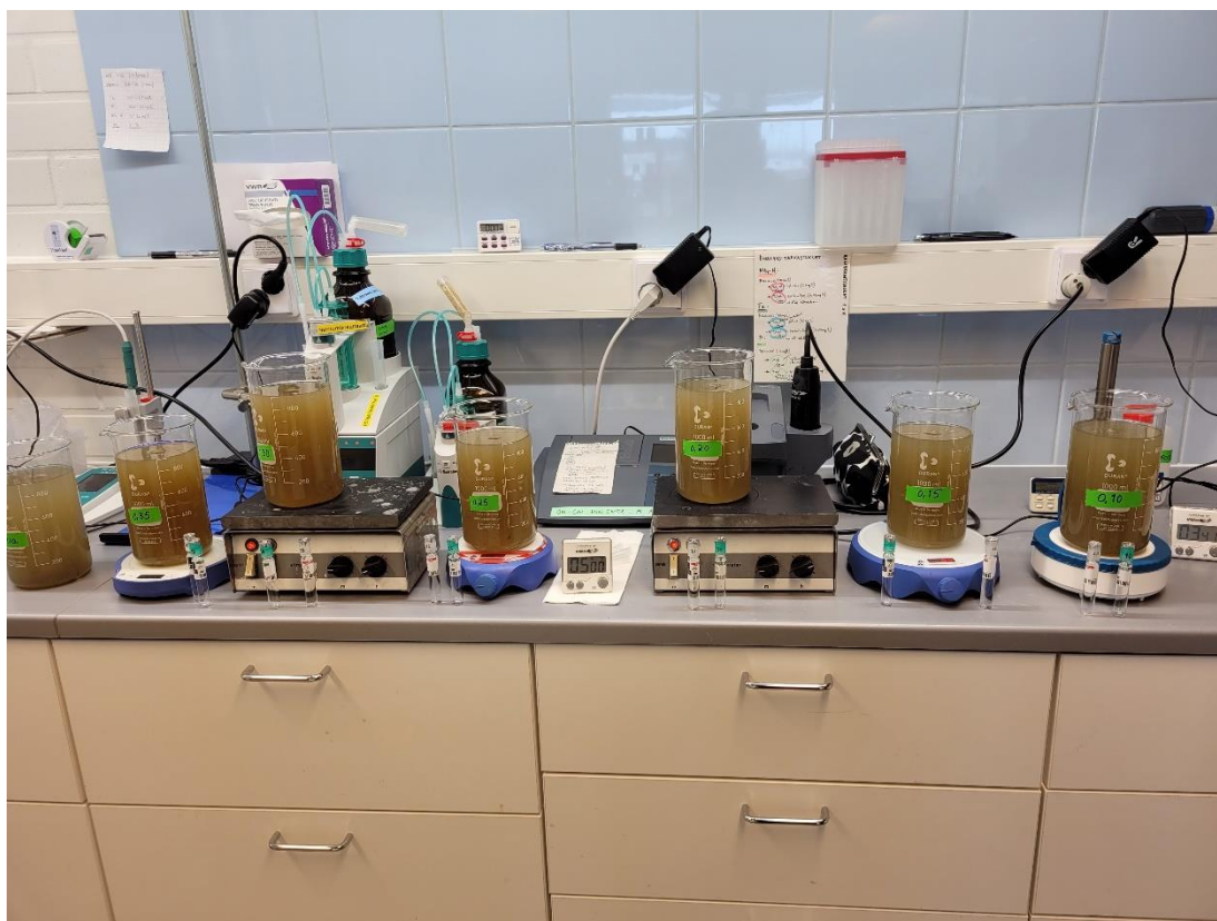
Kuva 5. Jätevesinäytteiden sekoittamista saostuskemikaalin annostelukokeessa.
