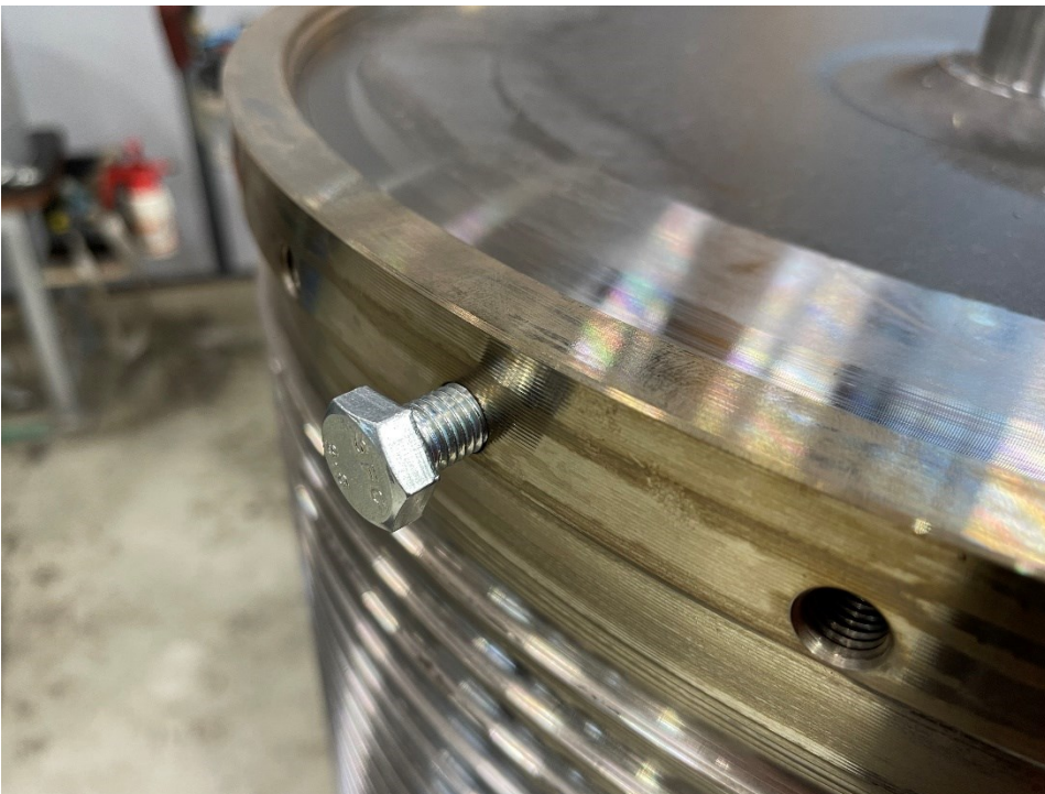
Kuva 13. M12 pultti valmiissa telassa, vapaapää kiinnitettyinä.
