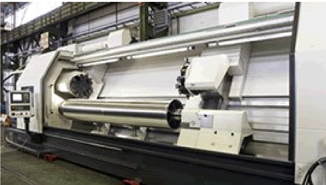
Kuva 5 QD-tela asetettuna tukilaakerien kanssa. (Heyligenstaedt, n.d.)
