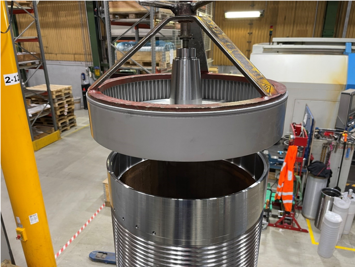
Kuva 6. Hammaskehän asettaminen lämmitettyyn telaan.
