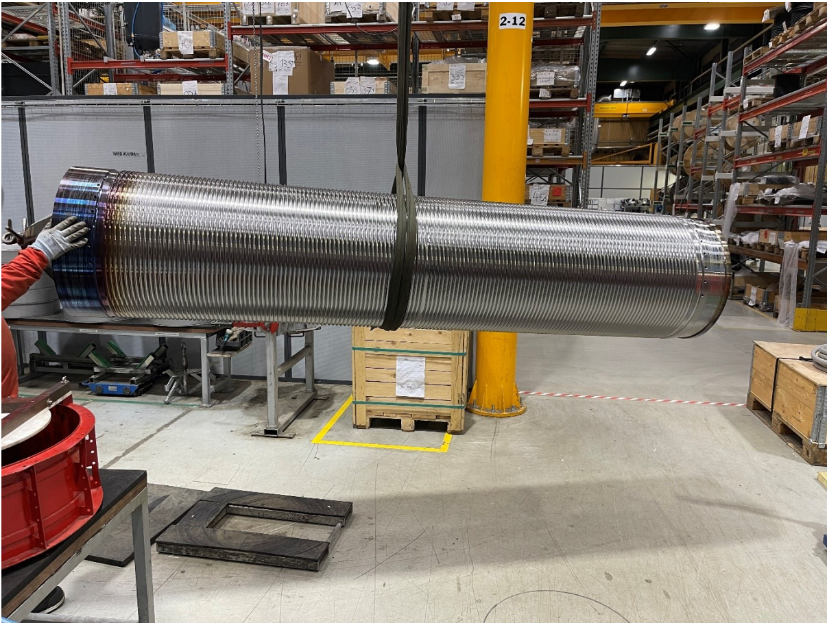
Kuva 8. Nostoliinan käyttäminen nostaessa teloja.
