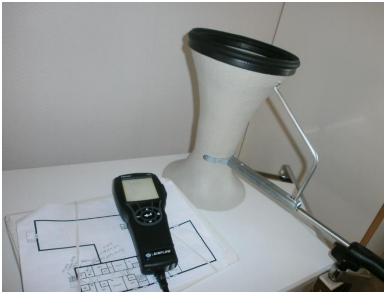
Kuvio 5. Ilmavirtamittauksissa käytetty kuumalanka-anemometri.
