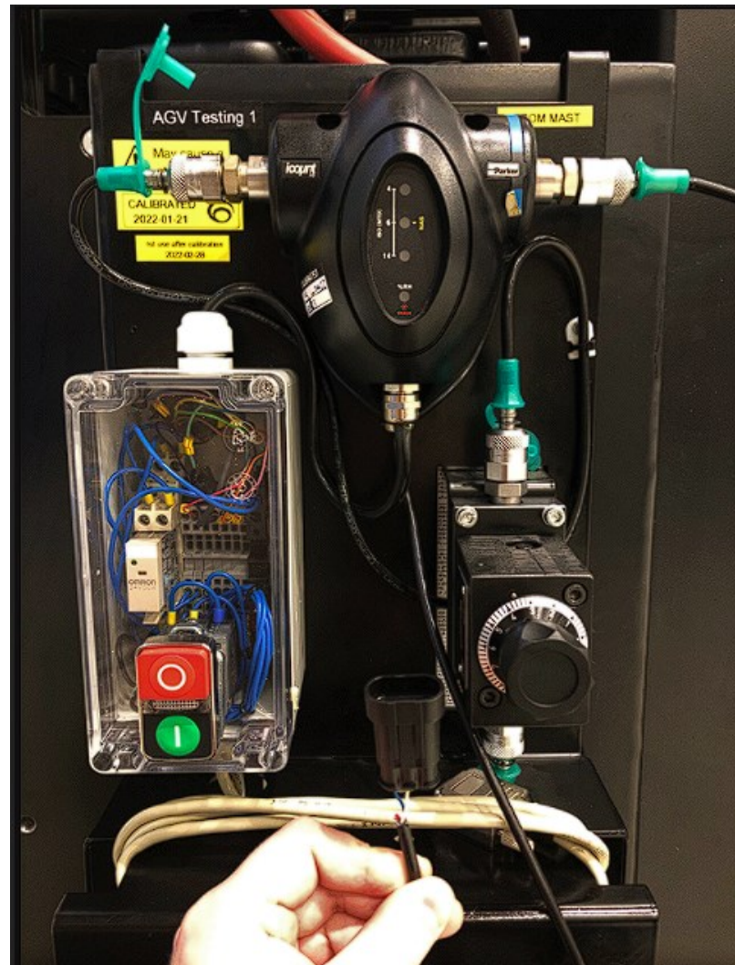
Kuva 5. iCountPD:n analysaattori. Kädessä näkyy relelähdön liitin.
