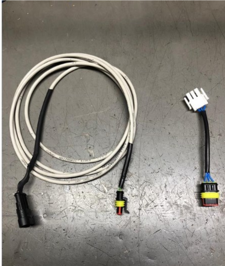
Kuva 7. Vasemmalla kommunikaatiokaapeli ja oikealla adapteri ATX-vihivau-nulle.
