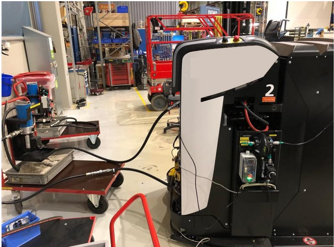
Kuva 17. Pumppu ja analysaattori kiinnitettynä vihivaunuun.
