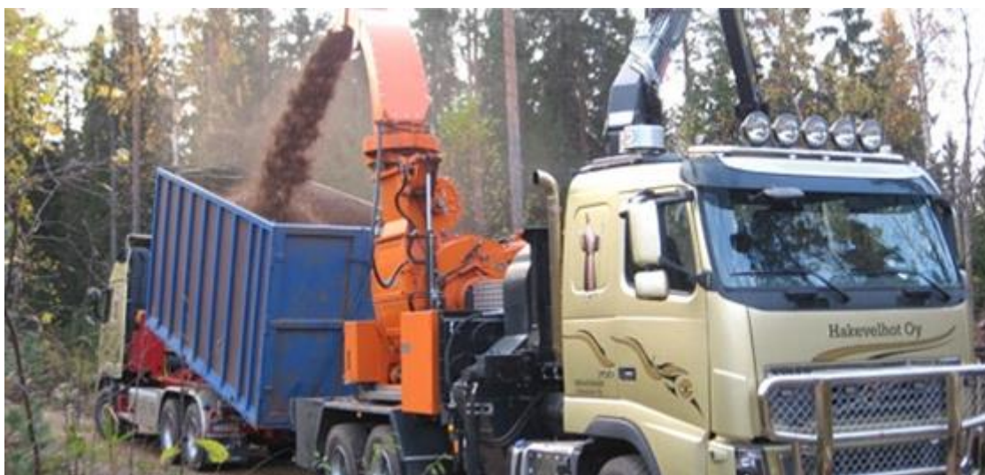
Bild 4. Skogsflisproduktion. Flishuggens skogsflis styrs in i en container. (Foto Metsäteho Oy, 2011)
