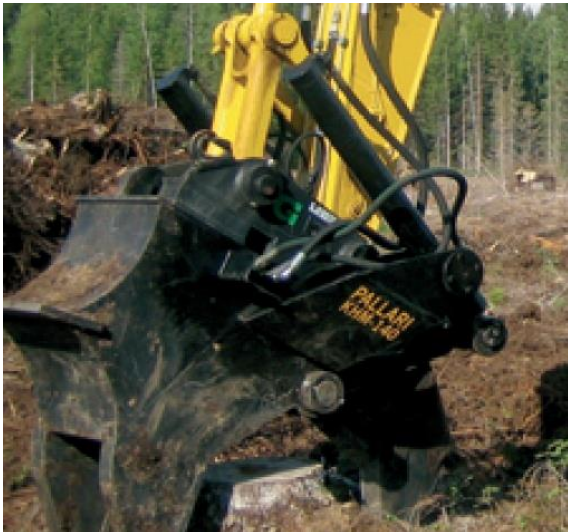
Bild 3. Stubbrytningsaggregat med hydraulisk giljotin ( Foto: Tervolan Konepaja, 2014)
