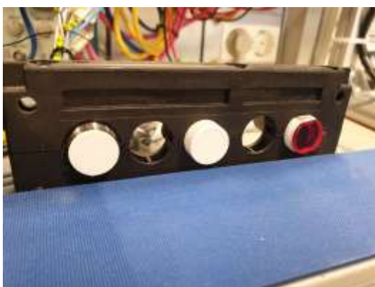
Kuva 13 Anturit (vas. oikeaan, Induktiivinen, Kapasitiivinen, Optinen).
