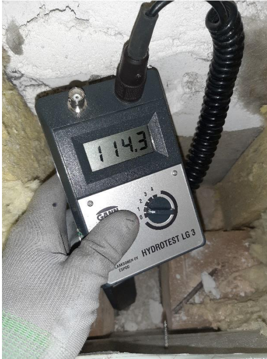
Kuva 16. Yleiskuvaa kosteusmittauksista. Alaohjauspuun alapuolisessa rakenteessa pintakosteusarvo korkeimmillaan noin 114 yksikköä, joka on tyypillistä tämän tyyppisissä rakenteissa. Alaohjauspuun alaosassa kosteus korkeimmillaan 13,7 p-%
