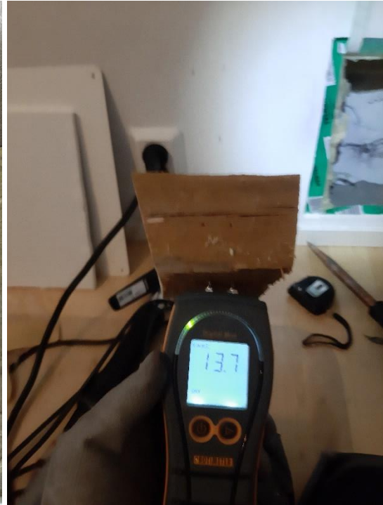
Kuva 16. Yleiskuvaa kosteusmittauksista. Alaohjauspuun alapuolisessa rakenteessa pintakosteusarvo korkeimmillaan noin 114 yksikköä, joka on tyypillistä tämän tyyppisissä rakenteissa. Alaohjauspuun alaosassa kosteus korkeimmillaan 13,7 p-%
