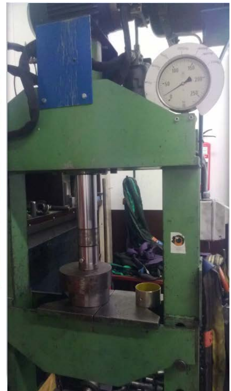
Kuvio 6. Laakerin koeasennus pesään. Vasemmalla lähtötilanne ja oikealla laakeri paikallaan.
