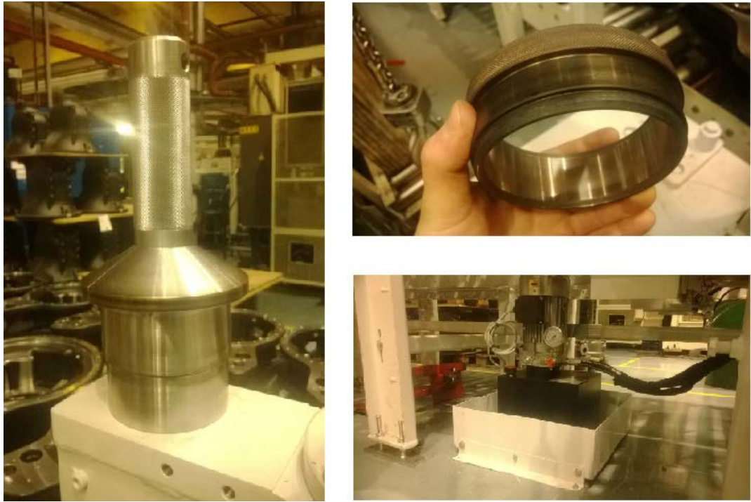
Kuvio 16. Oikealla asennustuurna, vasemmalla ylhäällä kiristysholkki ja vasemmalla alhaalla hydraulikkakoneikko ja valuma-allas
