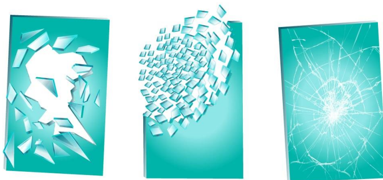
Figur 14. Beskriver skillnaderna i hur floatglas, härdat glas och laminerat glas reagerar vid kollision. (Henry's Glazcon, 2018).
