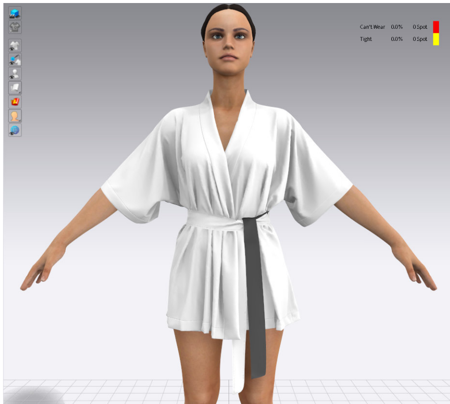
Kuva 36. Fit map mittaa materiaalin äärimmäistä vääristymää, joka määritetään materiaalin venyvyyden, vinouman ja taipuisuuden perusteella. Valkoinen väri (0 %) tarkoittaa, ettei materiaali ole venynyt lainkaan. Keltainen (yli 80 %) näyttää mistä kohdin vaate on tiukka. Punainen (yli 100 %) ilmoittaa vaatteen olevan niin tiukka, ettei sitä voi käyttää. Lukemia näytetään kohdista, joissa vaate on suoraan kosketuksissa avataren kanssa. (Clo3D 2021.)
