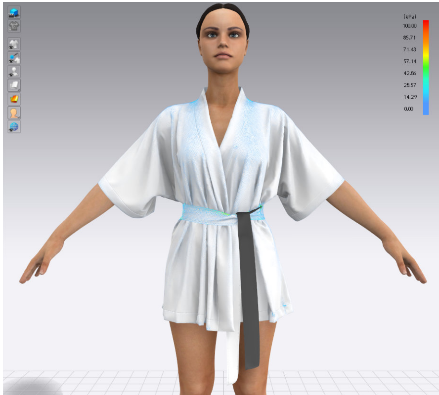
Kuva 34. Stress map kuvaa materiaalille aiheutuvaa ulkoista rasitusta. Rasitusta mitataan kilopascalina (kPa). Sininen tarkoittaa, ettei materiaaliin kohdistu ulkoista rasitusta (0 kPa). Punainen tarkoittaa suurinta mahdollista rasitusta ennen kuin kangas repeää (100 kPa). Luvut tällä välillä esitetään väriliukuman avulla. (Clo3D 2021.)
