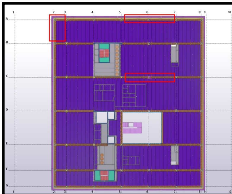
Figur 16. Olika anslutningar mellan kompositpelare och balkarna som har valts från Erica projekt. (Mohammadi, 2023).
