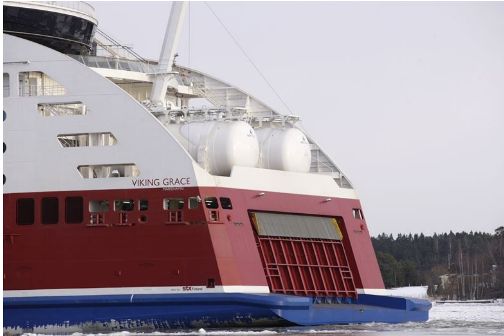
Kuva 3. M/S Viking Grace LNG-säiliöt aluksen peräkannella (Wärtsilä 2018).
