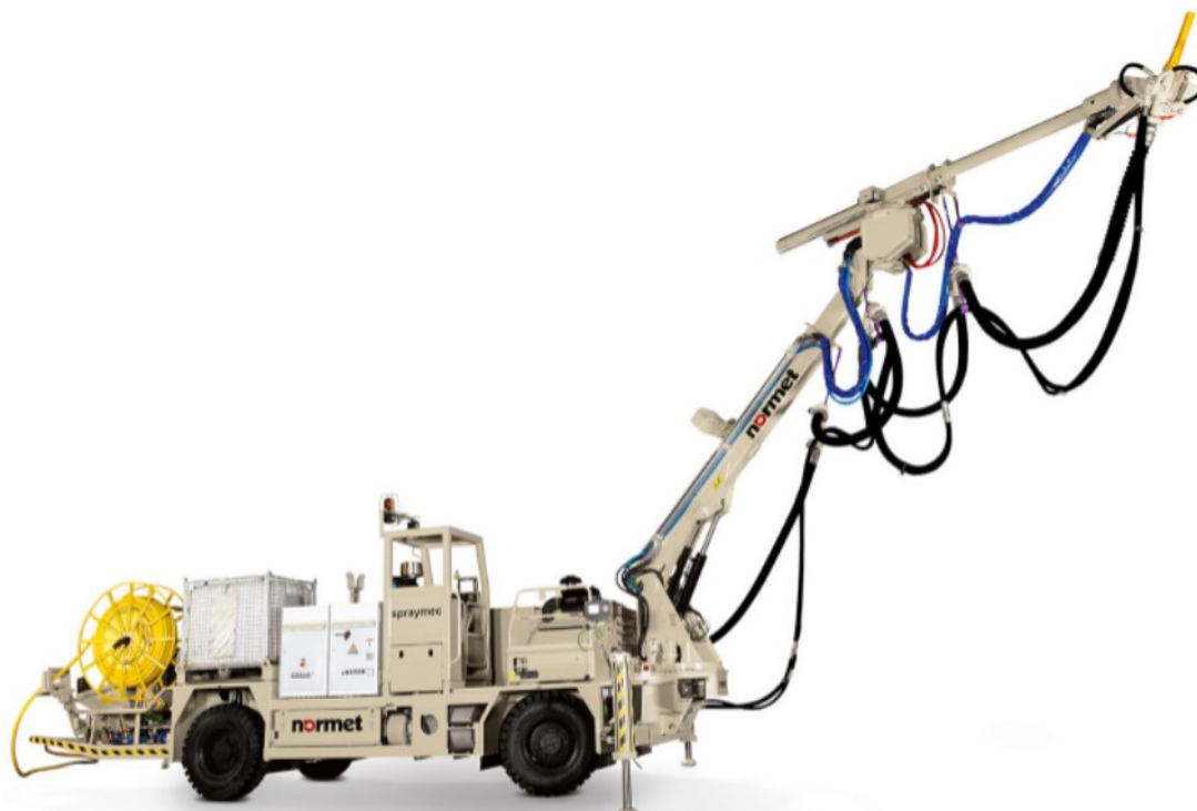
Kuva 7. 8100-sarjan laitteisiin on saatavilla ruiskubetonointia automatisoiva SmartSpray-järjestelmä. (Normet, 2023)
