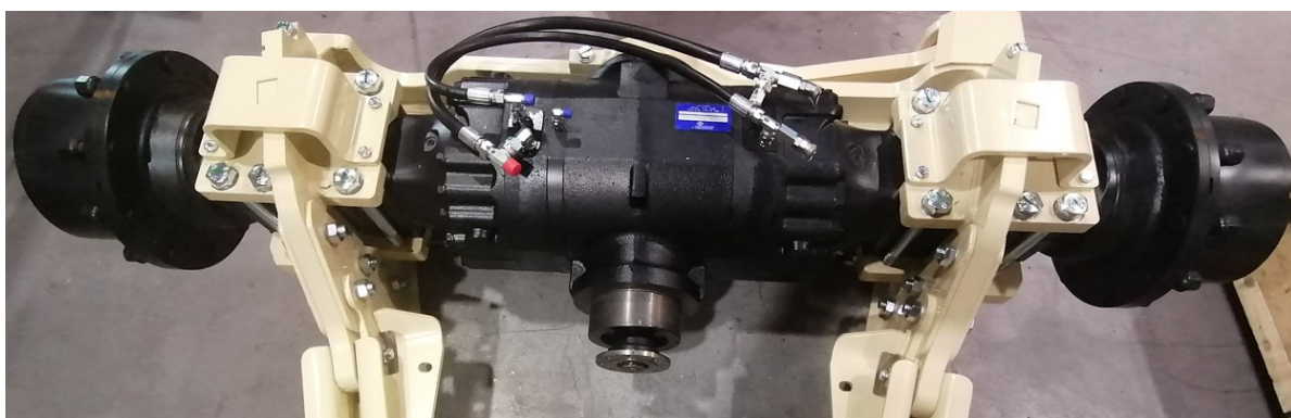
Kuva 19. Positiivisilla jarruilla varustetuissa akseleissa tarvitaan erillinen öljynsyöttö käyttö- ja turvajarrulle (Kaatrasalo 2023).
