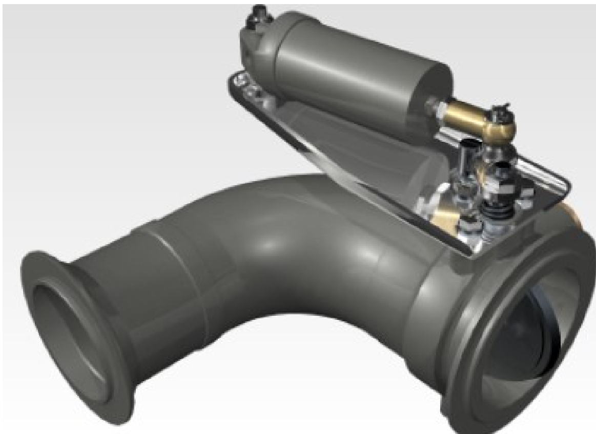
Kuva 21. Pakokaasun virtausta vastustavan läpän asentoa voidaan ohjata automaattisesti esimerkiksi kaasupolkimen asentoon perustuen. (Jacobs Vehicle Systems, 2023)
