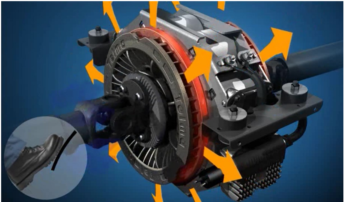
Kuva 23. Pyörrevirtahidastimessa kineettinen energia muuttuu lämmöksi. (Telma S.A.S, 2023)
