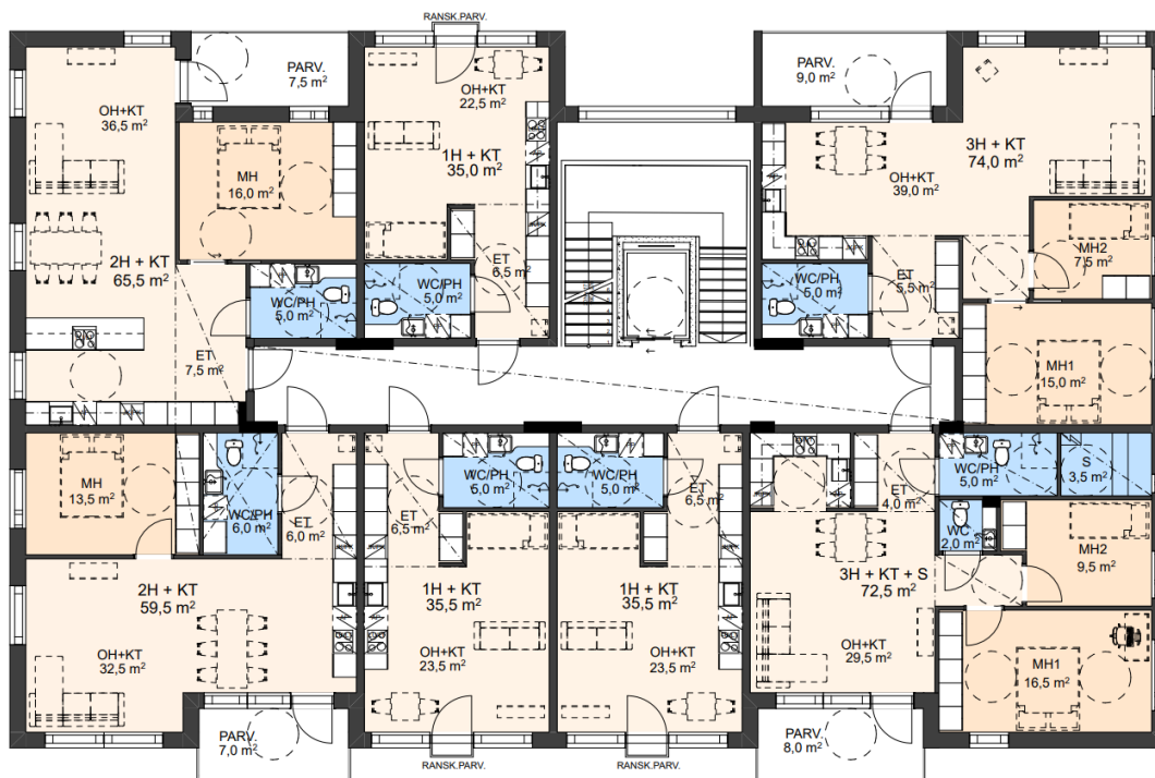
Kuva 14: Esimerkillisessä asuinkerrostalossa pyörähdysympyrät on sijoitettu kohtiin, joka mahdollistaa ovien ja kaappien avautumisen. (Kuva: Hautasuo, 2023)
