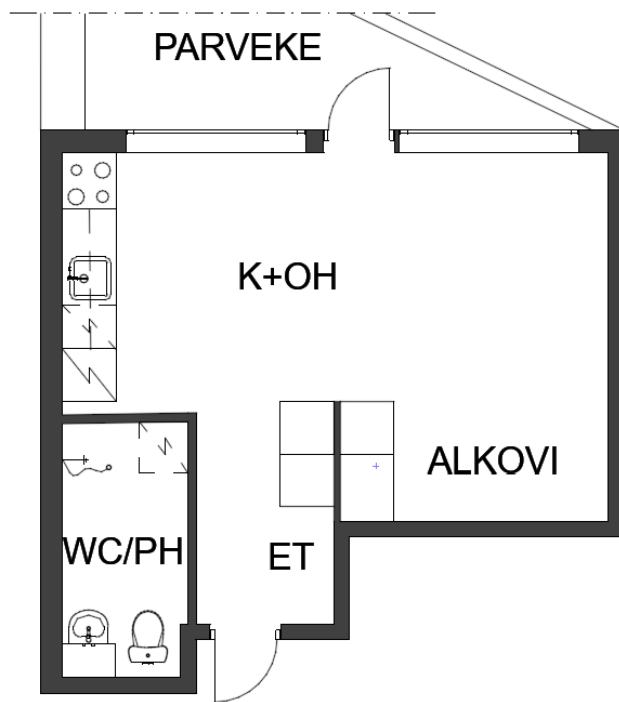
Kuva 47: Asuinkerrostalo, Turku, 2022. Wc-tilan puutteellisuuden lisäksi myös irtokalusteiden sijoittelu alkoviin vaikeutuu kaappien takia. Kaappien sijainnin takia sängyn voi sijoittaa ainoastaan tietyn suuntaisesti, jotta kaapille pääsy mahdollistuu. Kuva mallinnettu vuokrailmoituksen mukaan. (Kuva: Hautasuo, 2023)
