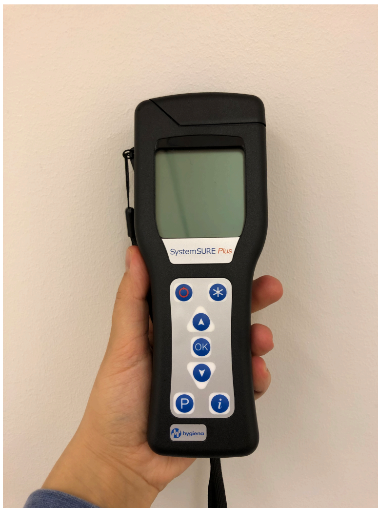
Kuva 3. Luminometri. Laitteen toiminta perustuu bioluminesenssireaktioon, josta syntyvän valon määrä on suoraan verrannollinen näytteen ATP-pitoisuuteen [16, s. 81].
