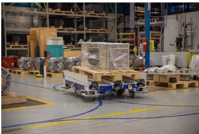
Kuva 24. Optinen navigaatio käytössä (www.flexqube.com).
