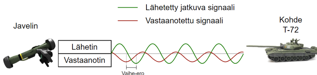
Kuva 27. ToF-kameran toimintaperiaate (vaihe-erokeilaus).
