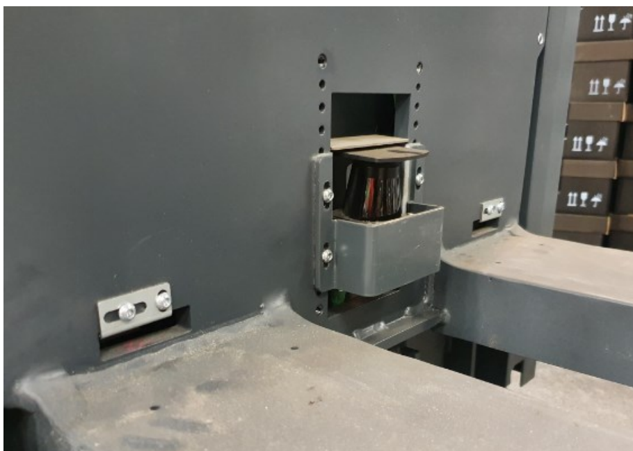
Kuva 60. lavan tunnistus -LiDAR (keskellä) sekä kaksi laser-etäisyysanturia.
