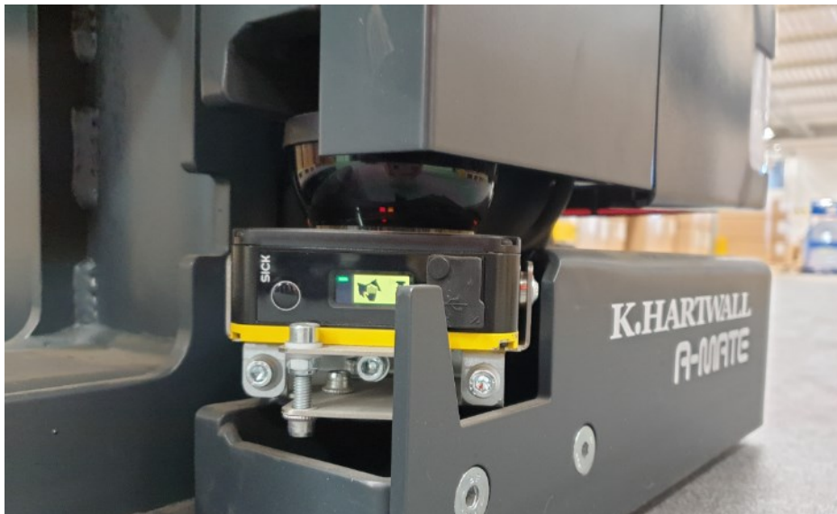
Kuva 57. A-Maten takaturva-anturin sijainti.
