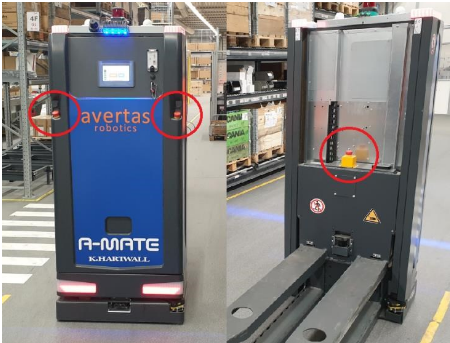
Kuva 58. A-Maten hätäseis-painikkeiden sijainti.
