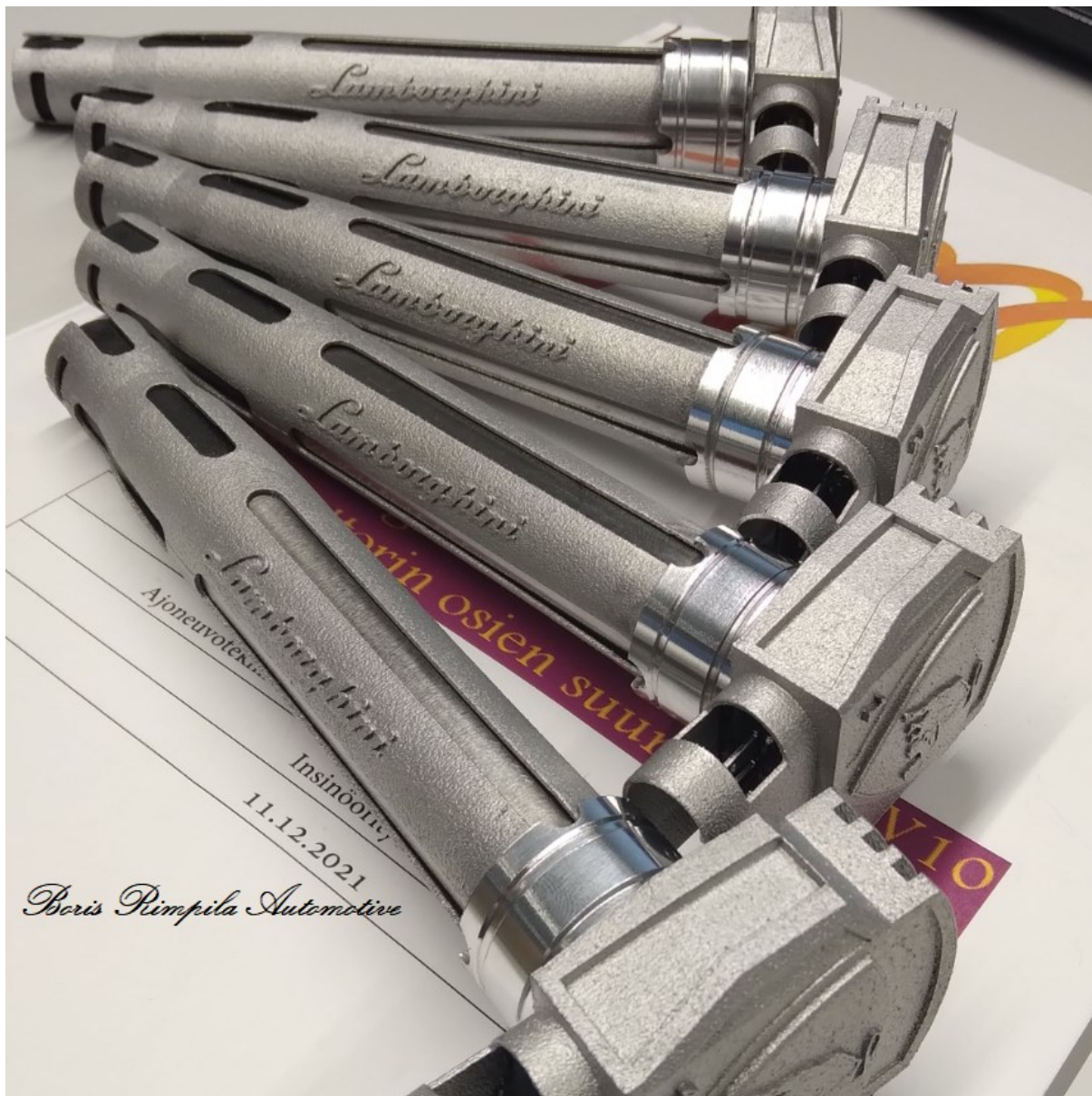
Kuva 46. Uusi suorasytytyspuolasarja on valmis
