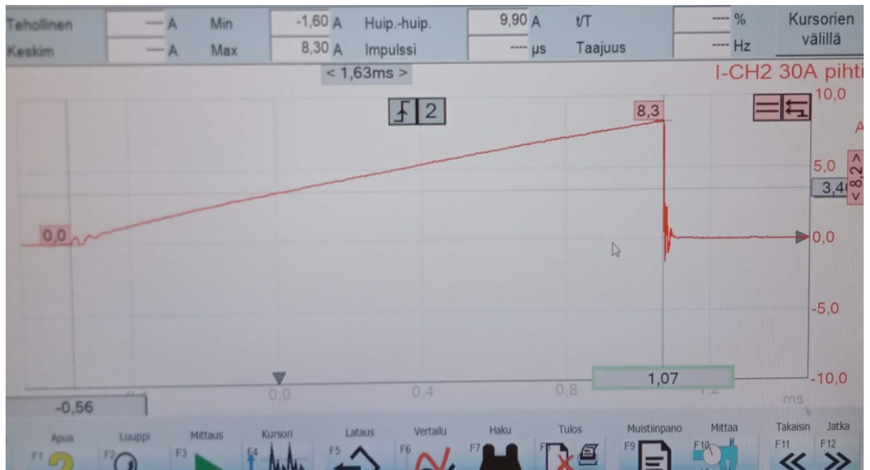
Kuva 16. Suorasytytyspuolan käyttöjännitejohdon mittaus virtapihdeillä
