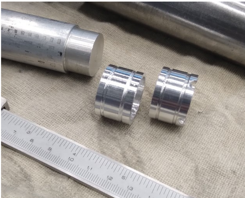
Kuva 40. Lämpösoviteholkin valmistus sorvissa
