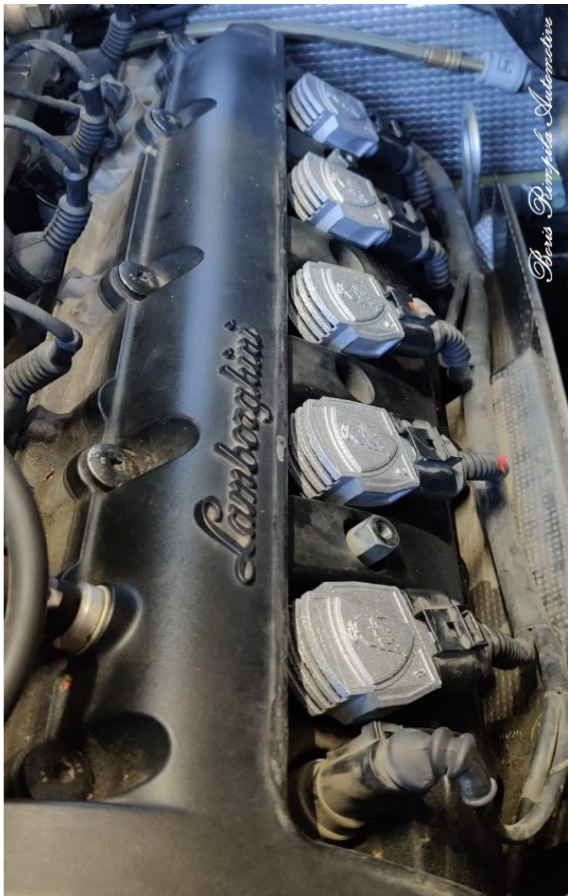
Kuva 49. Uudet suorasytytyspuolat asennettuina Gallardon moottoriin
