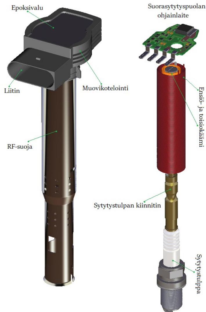
Kuva 3. Suorasytytyspuolan sisäinen sähköjärjestelmä
