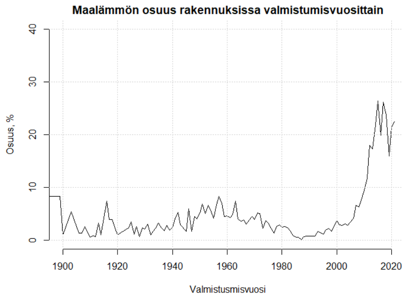
Kuva 5 Maalämmön osuus uusien rakennusten lämmitysmuotona valmistusvuosittain (Helsingin rakennukset 2023)
