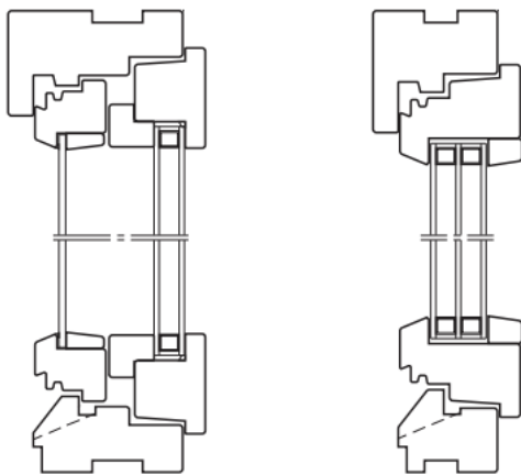
KUVA 3 Vasemmalta oikealle: SEK- ja SE-ikkunatyypit (2, s. 4)
