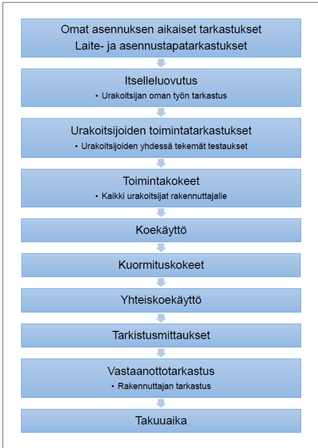
Kuva 17. Talotekniikan vastaanottoprosessi. [10, s. 211].
