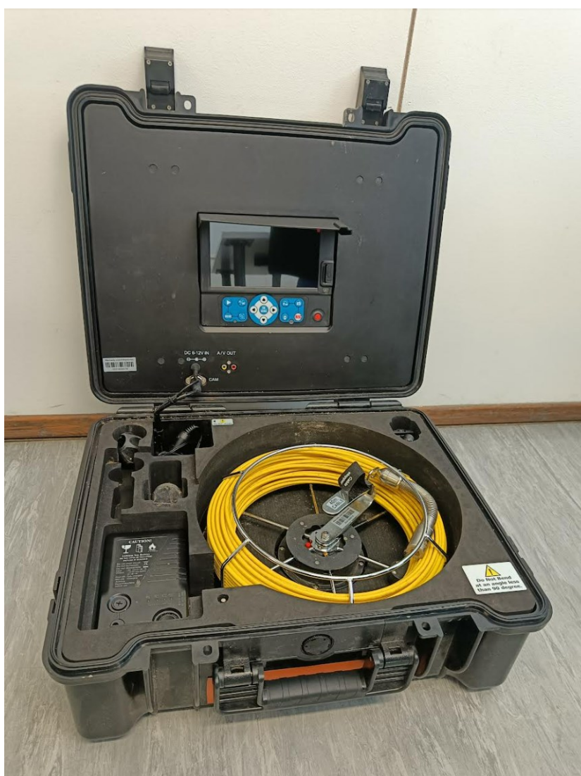
Kuva 11. Viemärikamera (Kuva: Sonja Sairomaa) [8].
