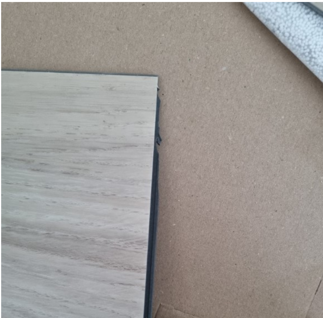
KUVA 6. Vinyylilankun haljennut pontti. (Nevalainen 2023)
