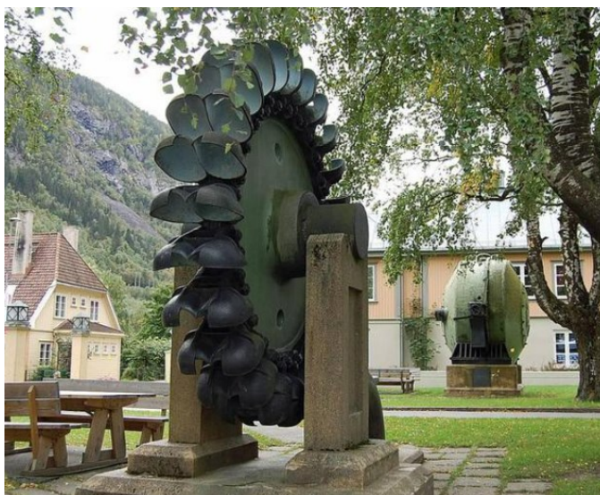
KUVA 5. Pelton -turbiini (Tekniikkatalous 2018)
