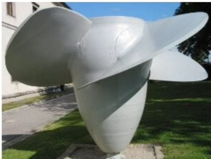
KUVA 3. Kaplan -turbiini (Hydropower's nature, Süsbrich 2023)
