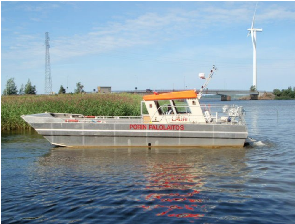
Kuva 5. E-luokan öljyntorjunta-alus (Satakunnan pelastuslaitos).
