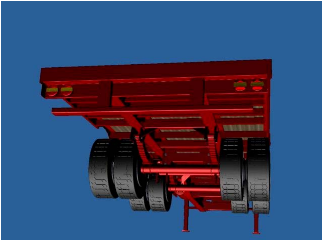
Kuva 28. Kolmiulotteinen malli puoliperävaunusta takaa.
