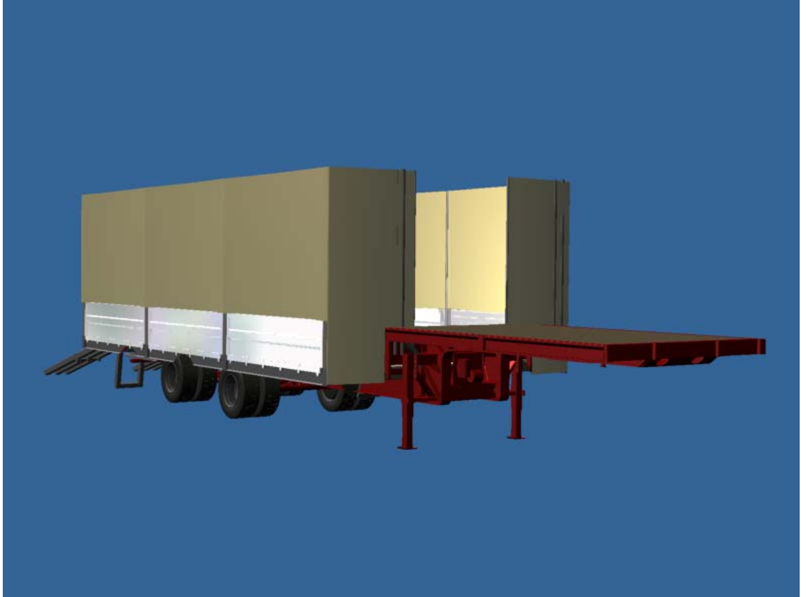
Kuva 32. Puoliperävaunu levitettyinä valmiina lastattavaksi.
