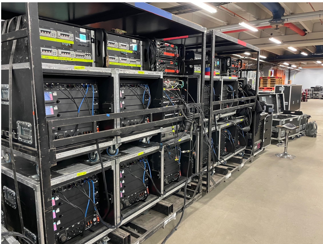
Kuva 34. Kaiutinjärjestelmän päätevahvistimet ja signaalin jakeluun liittyvät laitteistot rakennettuna ja kytkettynä ennen tapahtumaa varastolla. Laitteet on asennettu pyörällisille alustoille, joilla ne voidaan kuljettaa osittain valmiiksi kaapeloituna tapahtumapaikalle. Testiin ei ole otettu mukaan kaiuttimia, mutta koko järjestelmän muu osa on kytketty kuten se tapahtumassa tullaan tekemään ja varmistettu, että kaapelointi, verkkoliikenne ja signaalin reititys toimivat odotetusti. (Kuva: Terhi Salo 2022)
