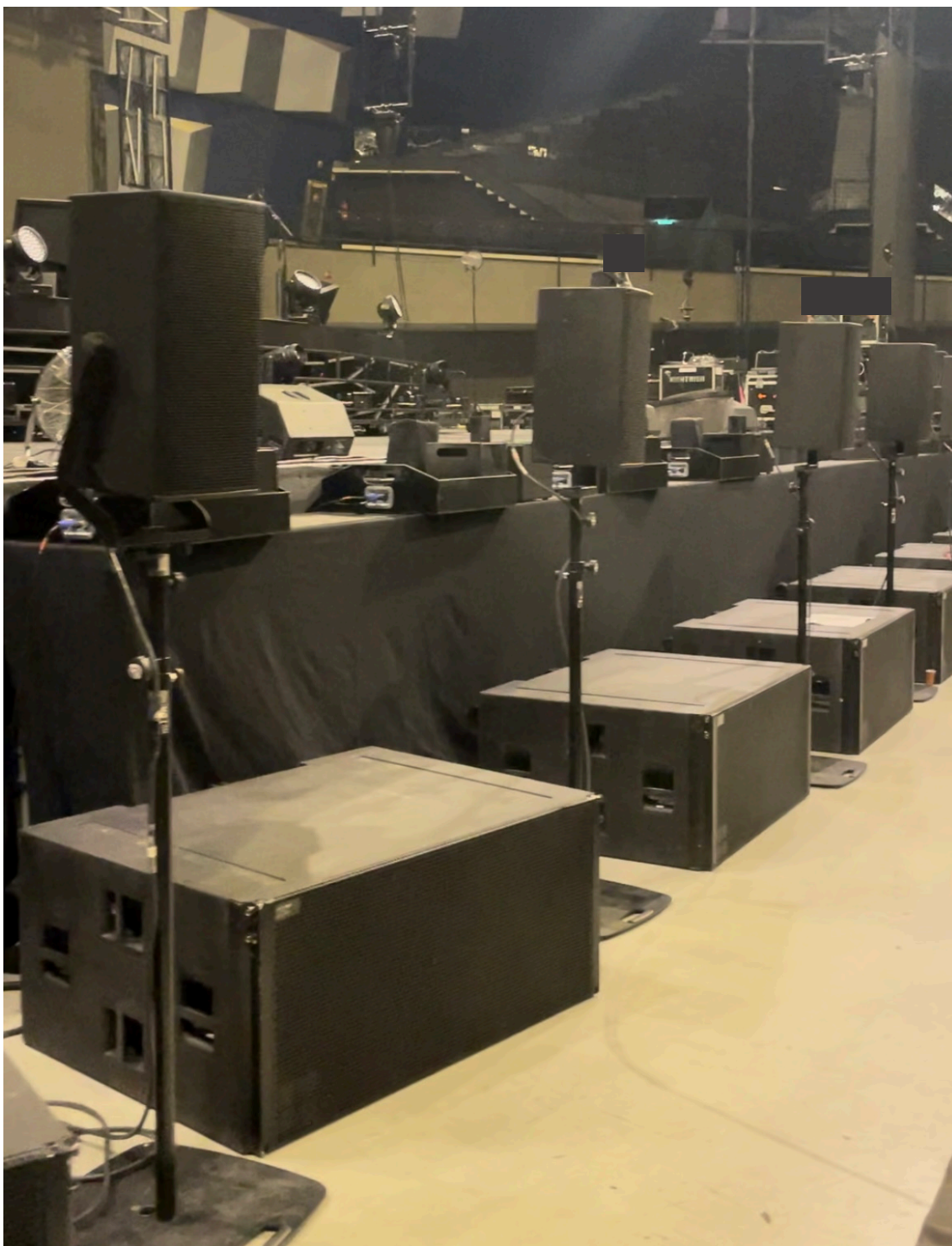
Kuva 5. Pystytelineille asennettuja point source -kaiuttimia, jotka toimivat tässä konsertissa laajemman järjestelmän apukaiuttimina, tässä tapauksessa etufil- leinä. Tolppien välissä maassa olevat suurehkot kaiuttimet ovat bassotaajuuksia toistavia subbeja. (Kuva: Terhi Salo 2022)
