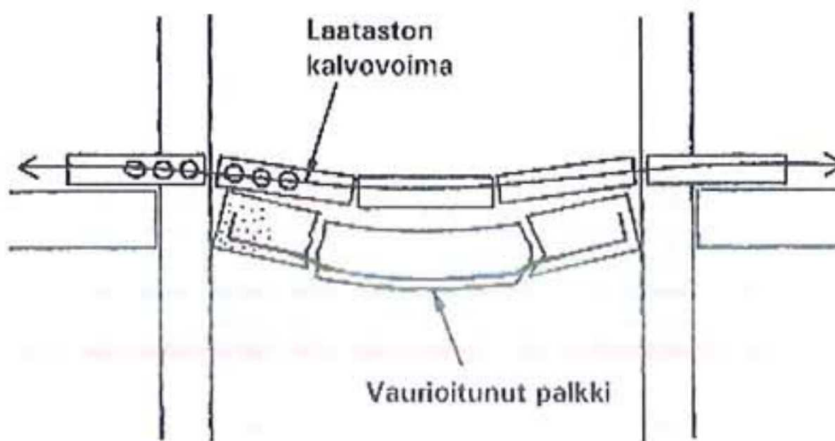
KUVA 19. Kalvorakenteen toimintaperiaate (Betoninormikortti 23, s23)
