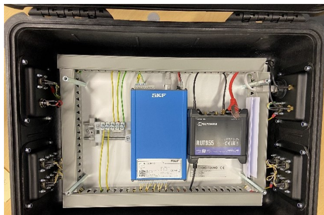
Kuva 4. IMx-salkun sisältö, jossa näkyy sisäosan komponentit
