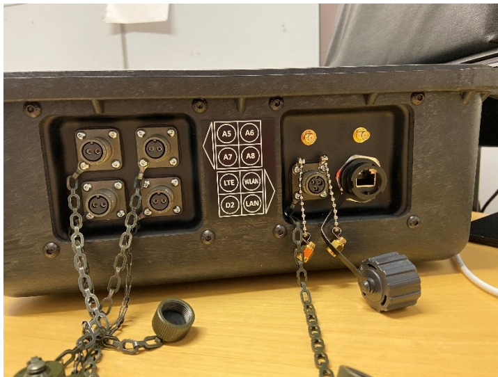
Kuva 6. IMx-salkun liitännät kuvattuna salkun oikealta puolelta
