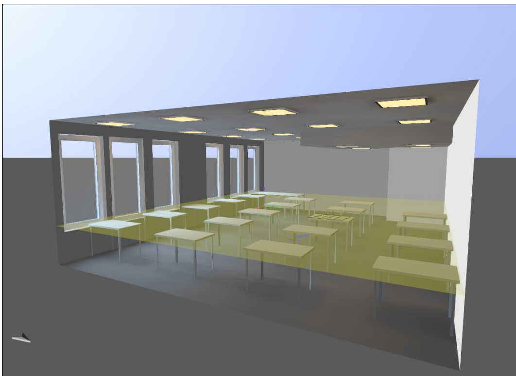
Kuva 4. C-siivessä sijaitsevan luokan Dialux malli.
