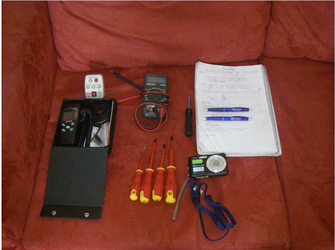
KUVA 4. Sähköasiantuntijan varustus kuntoarviossa
