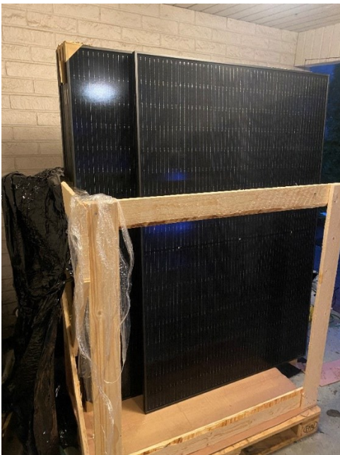
Kuva 3. Opinnäytetyön täysmustat yksikide half-cut-aurinkopaneelit (Kananoja, 2023).
