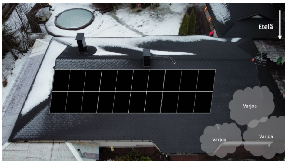
Kuva 18. Aurinkopaneelien suunniteltu sijainti katolla (Kananoja, 2023).
