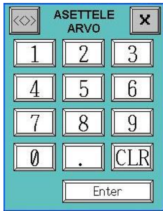
KUVA 22. Paikallisnäytön asetusarvojen pop up -ikkuna
