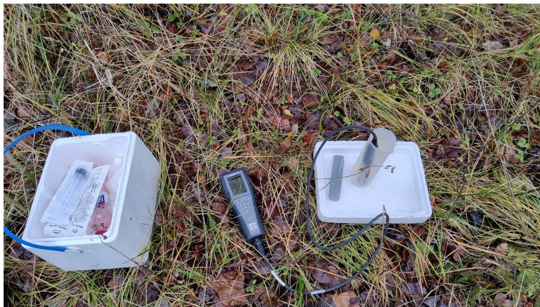
KUVA 5. Veden pH:n ja sähkönjohtavuuden mittaustapahtuma maastossa käyttäen YSI-vedenlaatumittaria (Holopainen 2023 CC BY-SA)
