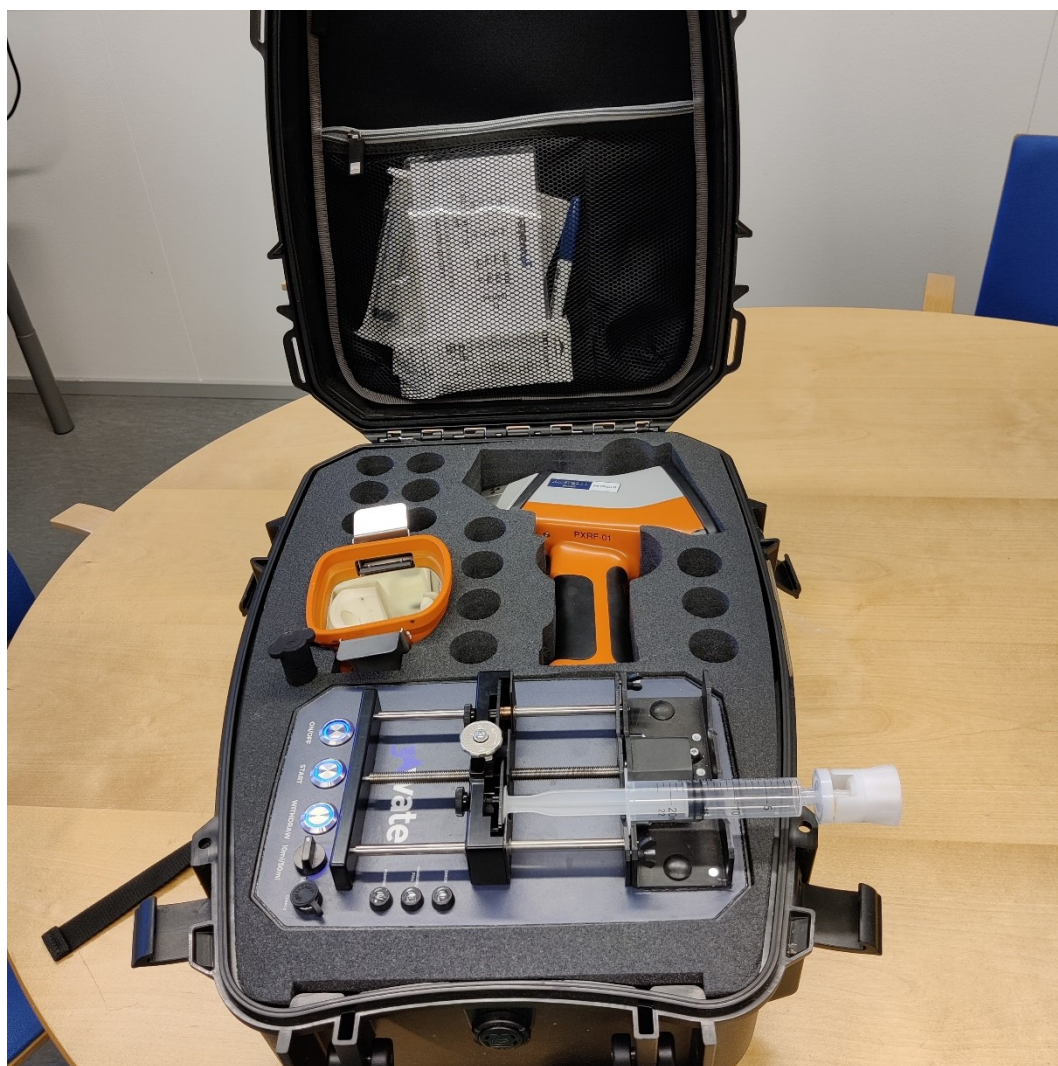
KUVA 1. MWAS kenttämittausmenetelmään kuuluva laitteisto sekä reppu (Holopainen 2023 CC BY-SA)
