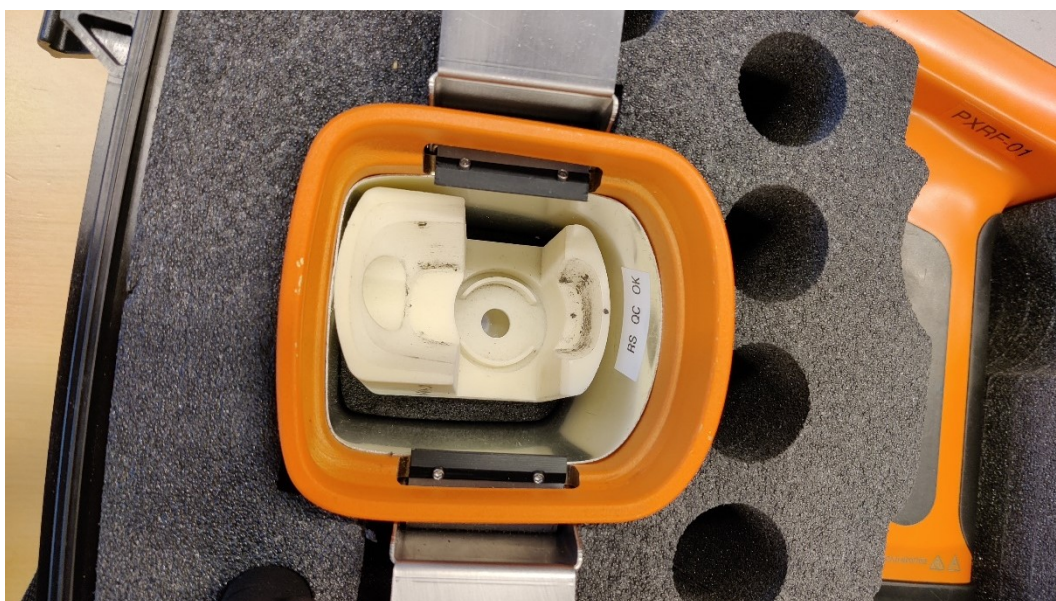
Kuva 7. Säteilysuoja ja sen sisällä oleva pidike nanofilterille XRF-mittausta varten (Holopainen 2023 CC BY-SA)
