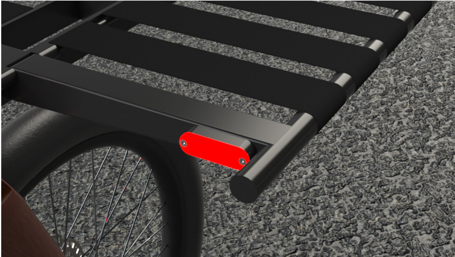
Kuva 26. Valoyksikön kotelo kuormapyörän lavassa
