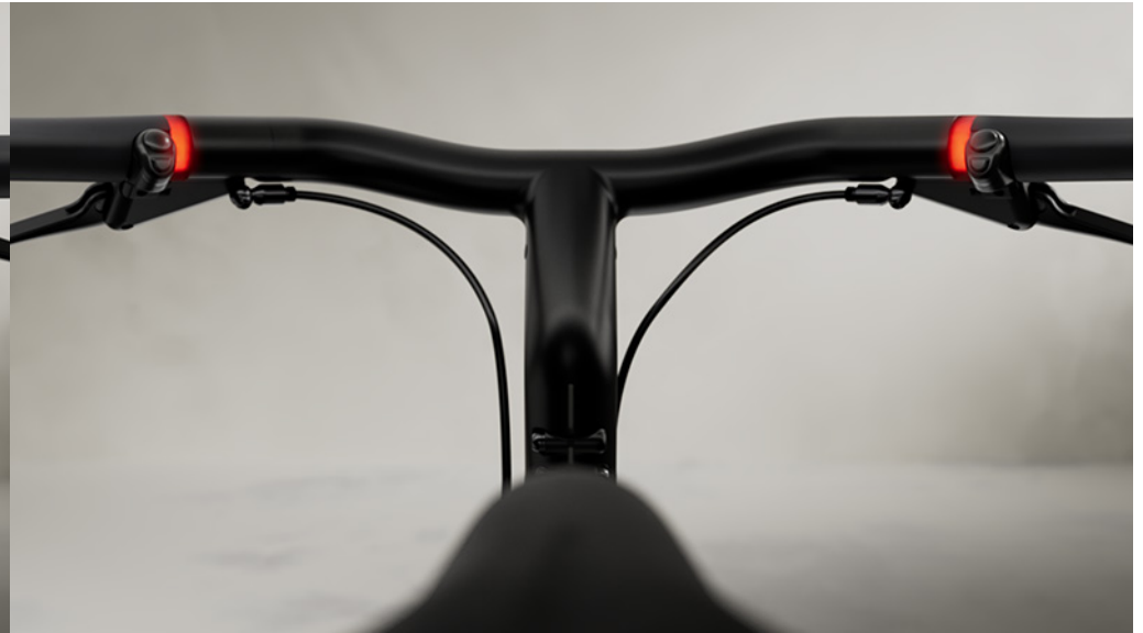
Kuva 11. Halo Ring -led-pilari virhetilassa
