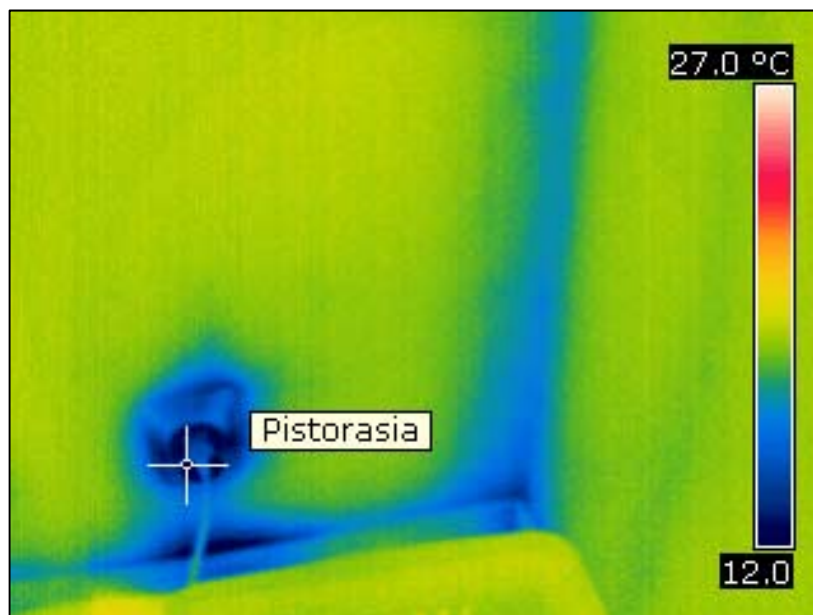
Kuvio 8: Pistorasian ilmapuoto lämpökuvattuna
