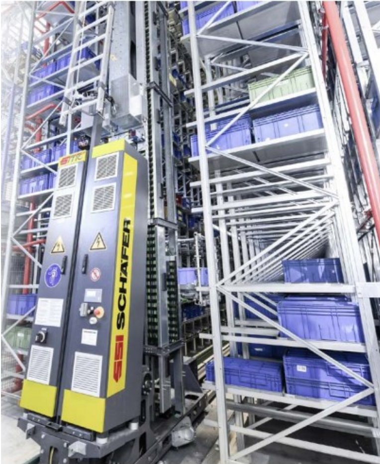
Kuvio 2. Miniload-varastoautomaatti kappaletavaralle (Ahlqvist ym. 2015, 14.)
