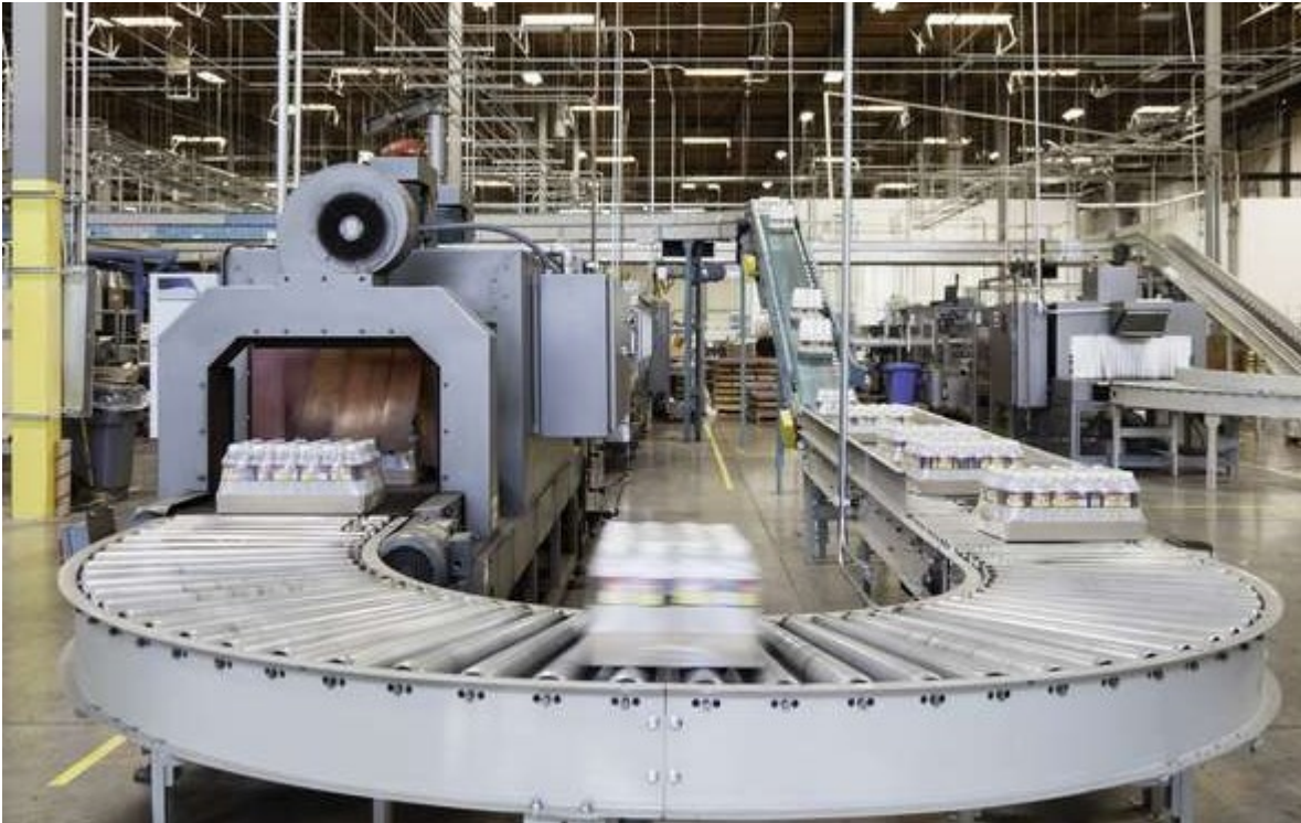
Kuvio 10. Havainnollistava kuvio rullakuljettimien toiminnasta (All About Roller Conveyors n.d.)
