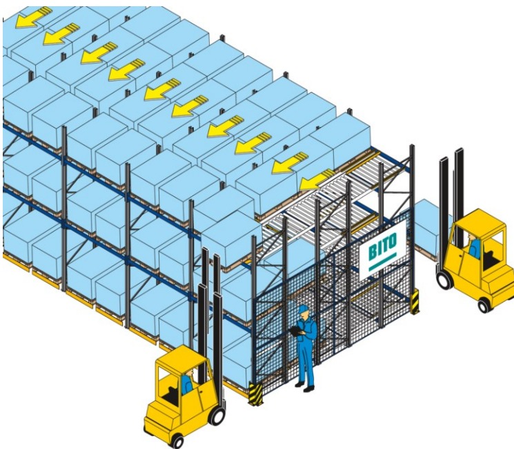
Kuvio 6. Läpivirtaushyllykön toimintaperiaate (Kuormalavan läpivirtausjärjestelmä PDS n.d.)
