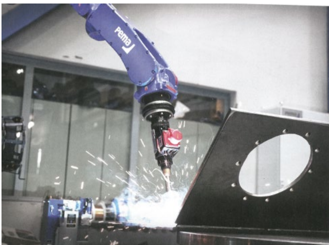
KUVIO 4. Hitsausrobotti työssään MAG-menetelmällä (Heinonen 2022, 253)
