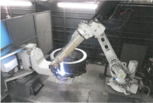
KUVIO 5. Hitsausrobotti, jonka lisälaitteena on kääntöpöytä (Heinonen 2022, 254)
