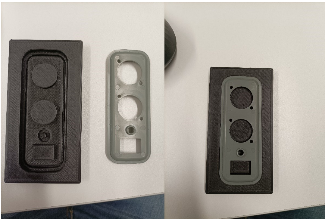
Kuva 3 ja 4. Esimerkkiosa ja -tulkki, ja niiden käytön havainnollistaminen (Kuvat: Vili Luostarinen)
