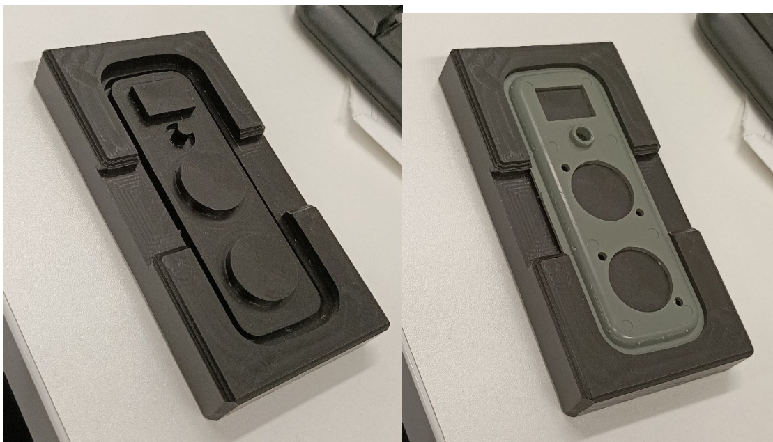
Kuva 12 ja 13. Esimerkkitulkki koneistetun versio 2:n toiminnan havainnollistaminen (Kuva Vili Luostarinen)
