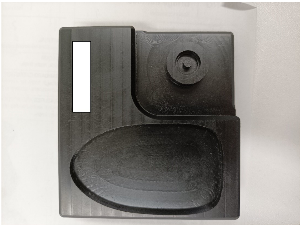
Kuva 11. Koneistettu kaksivaiheinen tulkki (Kuva: Vili Luostarinen)
