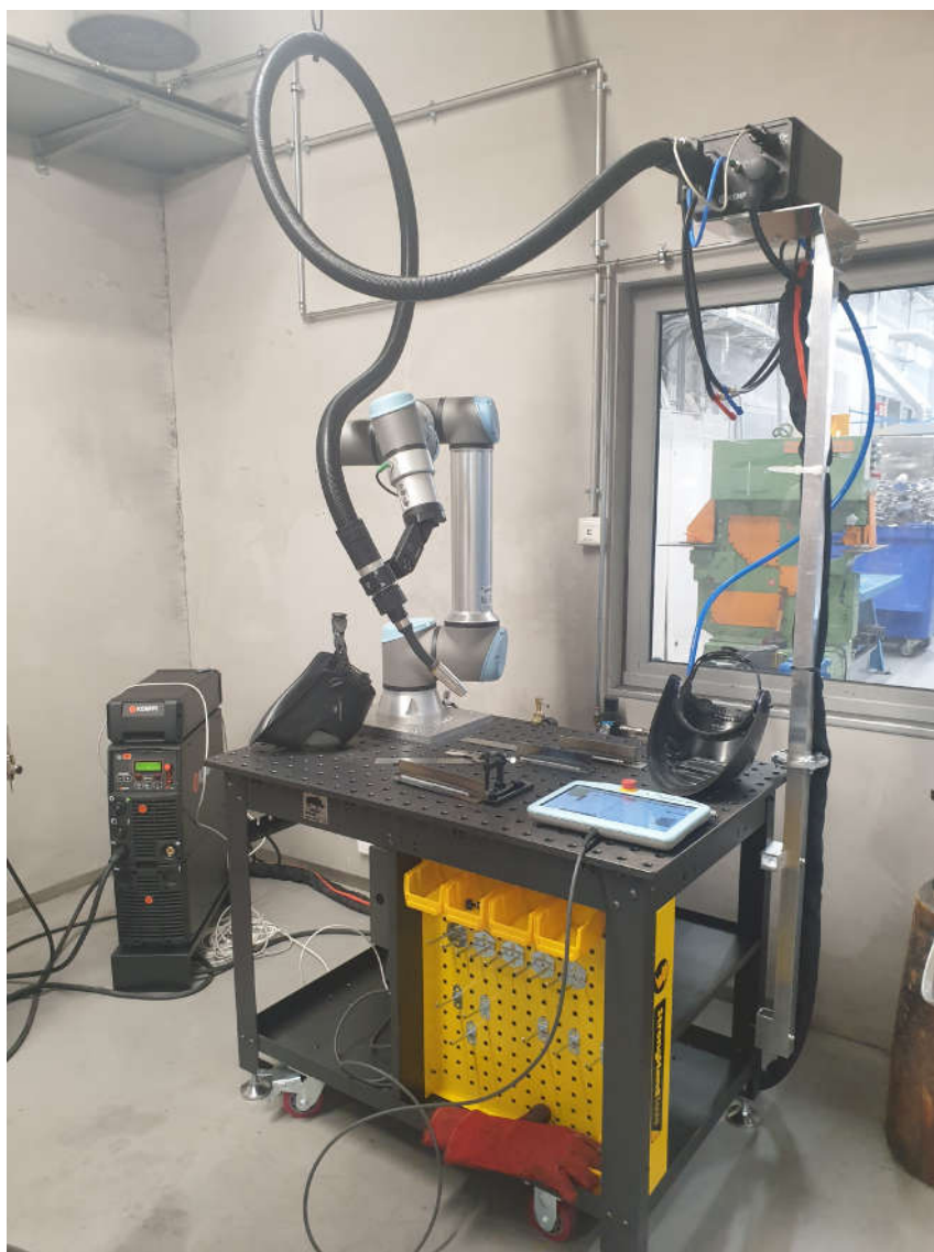
Kuva 6. Universal Robots UR10e -yhteistyörobotti Kempin hitsausjärjestelmällä Metropolian Leiritien-toimipisteessä.
