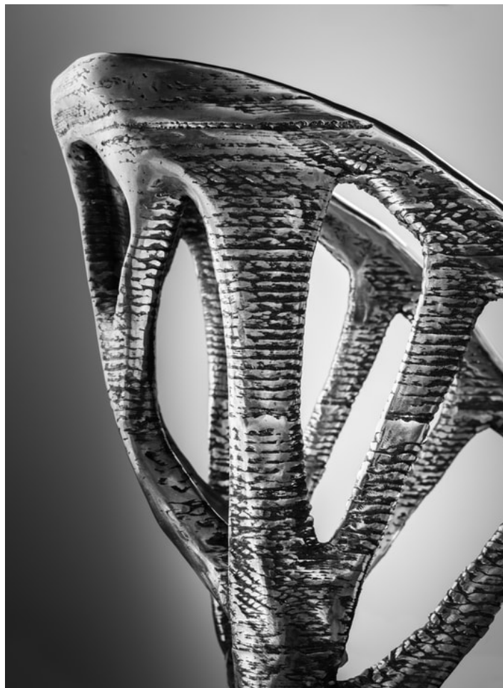
Kuva 12: Elbo Chair in Steel. MIG-hitsaamalla 3D-tulostettu tuoli (Bass 2015). Kuvan käyttöoikeudet saatu tekijältä.
