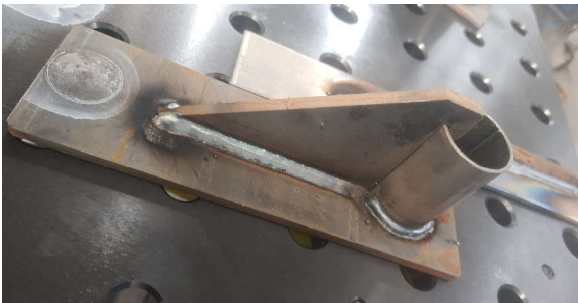
Kuva 7. Työstetty kappale ja yhteistyörobotin tuottama pienahitsi (kuva Daniel Korhonen 2022).
